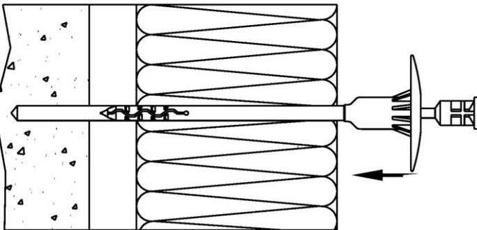
2) Dübel in das Bohrloch durch den Dämmstoff bis zur Anlage des Haltetellers auf dem Dämmstoff einsetzen.
