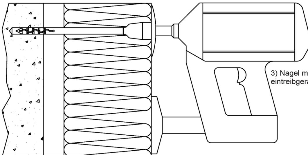
3) Nagel mit dem Nagel-eintreibgerät einschließen.
