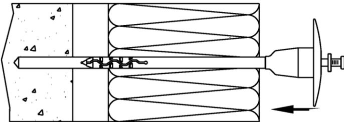
2) Dübel in das Bohrloch durch den Dämmstoff bis zur Anlage des Haltellers auf dem Dämmstoff einsetzen.
