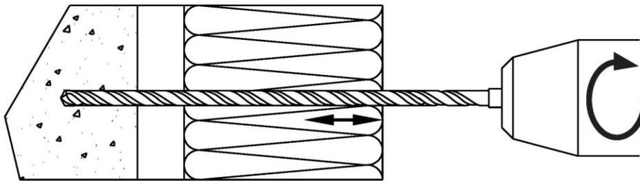
1) Bohrloch senkrecht zur Oberfläche erstellen.
