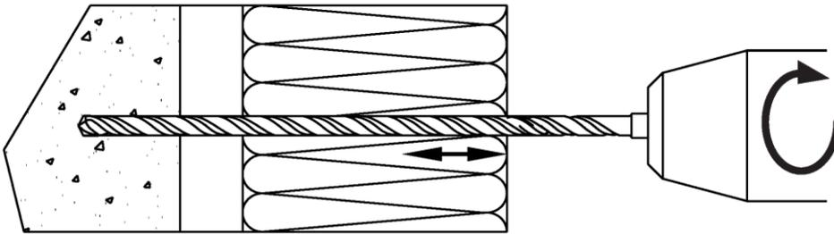
1) Bohrloch senkrecht zur Oberfläche erstellen.
