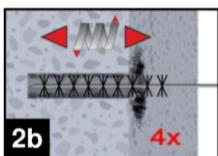
2b. Der Bürstendurchmesser ist zu überprüfen (Tabelle B5). Bohrloch mit geeigneter Bürste  $> d_{b,min}$  (Tabelle B5) mindestens vier Mal mittels Drehbewegung ausbürsten. Bei tiefen Bohrlöchern ist eine geeignete Bürstenverlängerung (Tabelle B5) zu benutzen.
