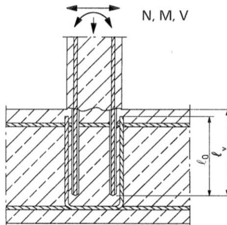
**Bild A3:** Endverankerung von Platten oder Balken
