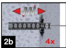
2b. Der Bürstendurchmesser ist zu überprüfen (Tabelle B5). Bohrloch mit geeigneter Bürste  $> d_{b,min}$  (Tabelle B5) mindestens 4x mittels Drehbewegung ausbürsten. Bei tiefen Bohrlöchern ist eine geeignete Bürstenverlängerung zu benutzen.
