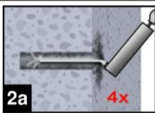
2a. Das Bohrloch vom Bohrlochgrund her 4x vollständig oder Handpumpe (Anhang B 7) ausblasen.
