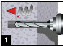
1. Bohrloch mit dem Durchmesser und der Bohrlochtiefe entsprechend des gewählten Bewehrungsseisens mit Hammerbohrer (HD), Hohlbohrer (HDB) oder Druckluftbohrer (CD) in den Untergrund bohren. Bei Fehlbohrungen ist das Bohrloch zu vermörteln.
