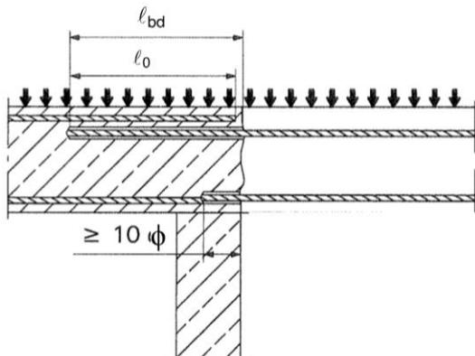
**Bild A2:** Übergreifungsstoß einer biegebeanspruchten Stütze oder Wand an ein Fundament
