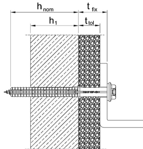
Einbauzustand SDF-10H in einer Wetterschale ( $h_{nom}$ )
