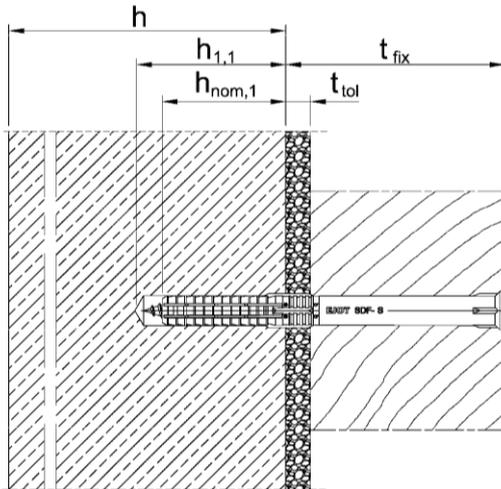
Einbauzustand SDF-10V in Beton ( $h_{nom1}$ )
