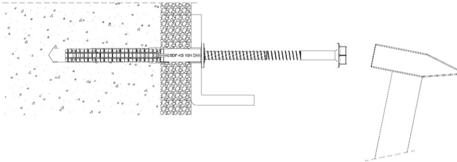
3. Die Schraube wird eingeschraubt, bis der Schraubenkopf die Dübelhülse berührt
