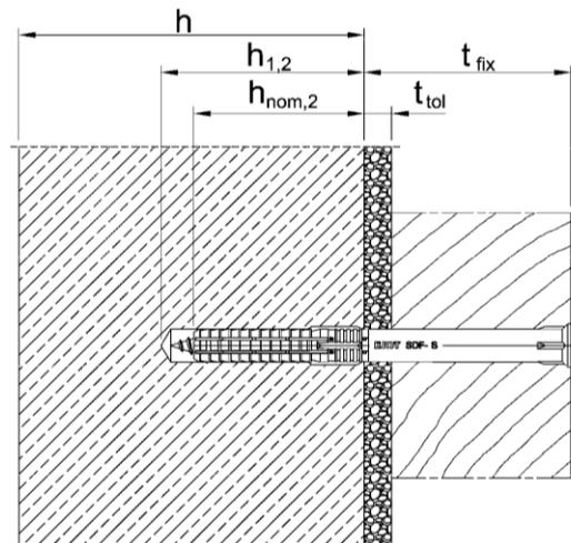
Einbauzustand SDF-10V in Vollstein ( $h_{nom2}$ )
