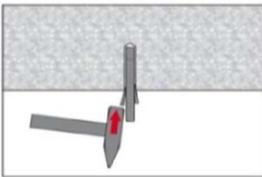
Bei Überkopfanwendung das Element in seiner endgültigen Position z.B. mittels Keilen gegen Herausrutschen sichern.
