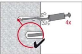
Für Bohrlochdurchmesser  $d_0 \leq 20$  mm und Verankerungstiefen  $h_{ef} \leq 10 \cdot d$  kann die Hilti Handausblaspumpe verwendet werden. Das Bohrloch mindestens 4-mal mit der Hilti Ausblaspumpe vom Bohrlochgrund ausblasen, bis die rückströmende Luft staubfrei ist.
