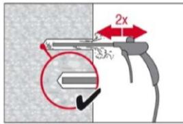
Bohrloch 2-mal vom Bohrlochgrund über die gesamte Länge mit ölfreier Druckluft (min. 6 bar bei 6 m<sup>3</sup>/h; falls notwendig mit Verlängerung) ausblasen, bis die rückströmende Luft staubfrei ist.
