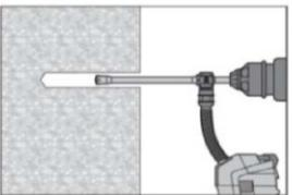
Die Bohrlocherstellung bis zur erforderlichen Setztiefe erfolgt dreh Schlagend mit einem Hilti Hohlbohrer TE-CD oder TE-YD mit Hilti Staubsaugeranschluss. Dieses Bohrsystem beseitigt bei Anwendung gemäß der Gebrauchsanweisung des Hohlbohrers das Bohrmehl und reinigt das Bohrloch während des Bohrvorgangs. Nach Beendigung des Bohrens kann mit Mörtelverfüllung gemäß Montageanweisung begonnen werden.
