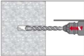
Bohrloch mit Bohrerhammer dreh Schlagend, unter Verwendung des passenden Bohrerdurchmessers auf die richtige Bohrtiefe erstellen.
