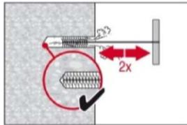
2-mal mit Stahlbürste in passender Größe (siehe Tabelle B8) bürsten. Stahlbürste Hilti HIT-RB mit einer Drehbewegung in das Bohrloch bis zum Bohrlochgrund einführen und wieder herausziehen (falls notwendig mit Verlängerung).
