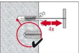
4-mal mit Stahlbürste in passender Größe (siehe Tabelle B8) bürsten. Stahlbürste Hilti HIT-RB mit einer Drehbewegung in das Bohrloch bis zum Bohrlochgrund einführen und wieder herausziehen (falls notwendig mit Verlängerung). Die Bürste muss beim Einführen einen Widerstand erzeugen (Bürste  $\varnothing \geq$  Bohrloch  $\varnothing$ ) – falls nicht, ist die Bürste zu klein und muss durch eine größere Bürste ersetzt werden.
