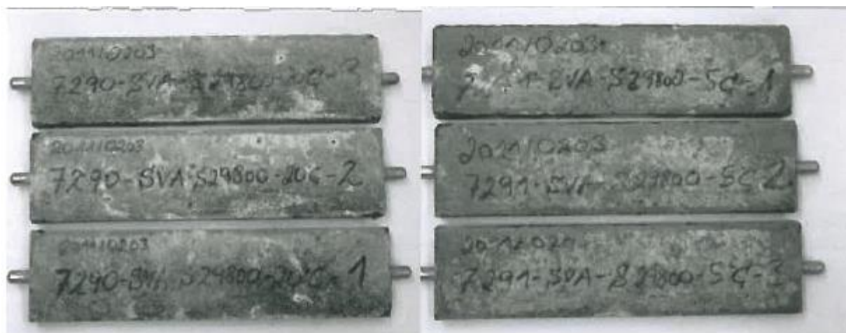
Bild A3: Probekörper mit CEM I 42,5 R-SR0 nach 180 Tagen; Lagerung in \text{Na}_2\text{O}_4 -Lösung: 20 °C-Lagerung (links) und 5 °C-Lagerung (rechts)
