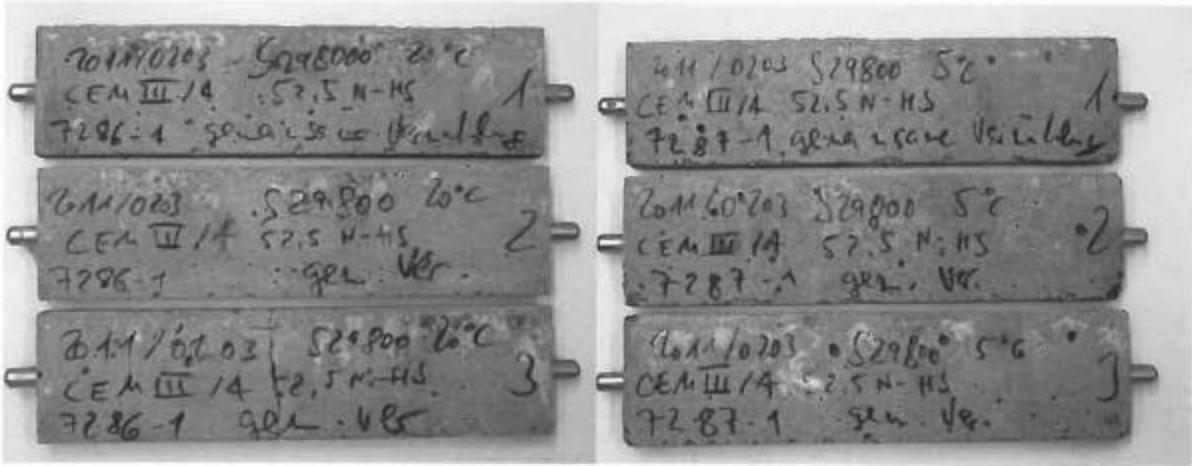
Bild A1: Probekörper aus CEM III/A 52,5 N-SR "Ennigerloh" nach 180 Tagen; Lagerung in \text{Na}_2\text{O}_4 -Lösung: 20 °C-Lagerung (links) und 5 °C-Lagerung (rechts)
