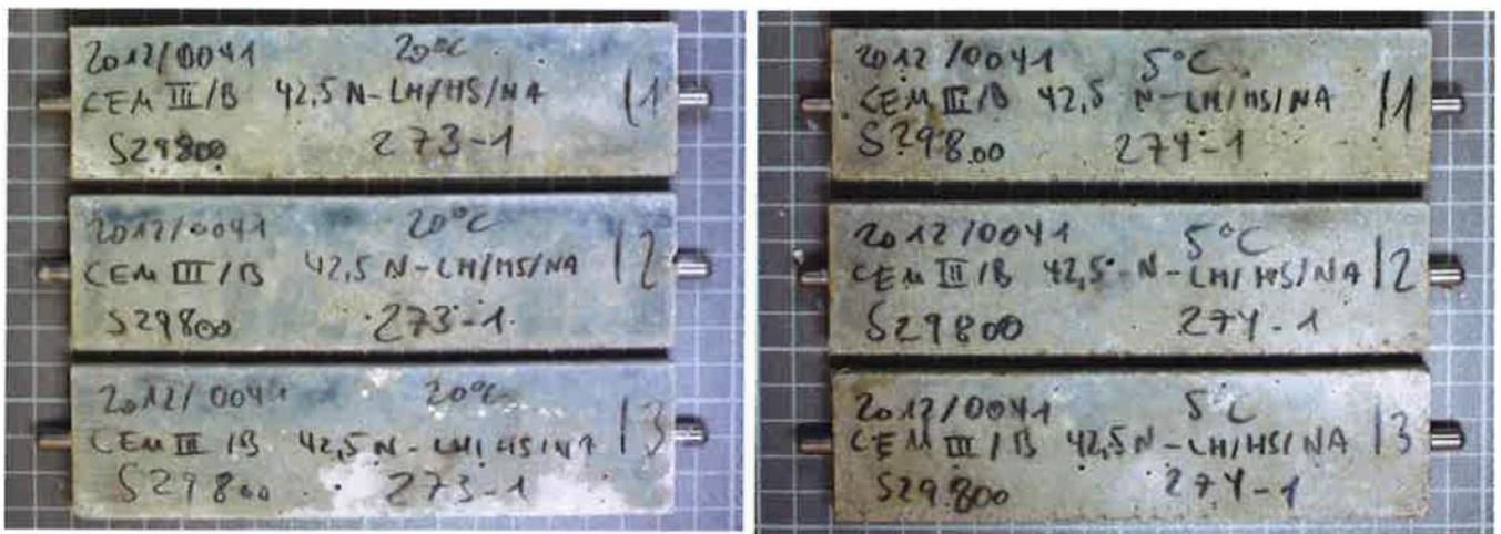
Bild A4: Flachprismen aus Hochofenzement CEM III/B 42,5 N-LH/SR nach 180 Tagen Lagerung in Na<sub>2</sub>SO<sub>4</sub>-Lösung bei 20 °C (links) und 5 °C (rechts)
