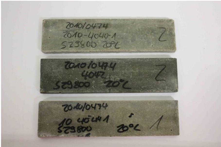
Bild A1: Flachprismen nach 180 Tagen Lagerung in Na<sub>2</sub>SO<sub>4</sub>-Lösung bei 20 °C
