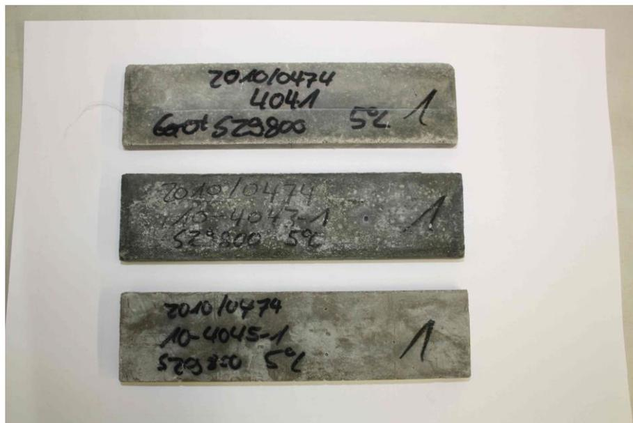
Bild A2: Flachprismen nach 180 Tagen Lagerung in Na<sub>2</sub>SO<sub>4</sub>-Lösung bei 5 °C
