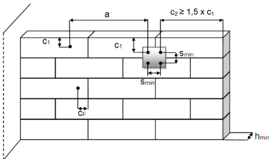
**fischer Porenbetonanker FPX-I**
