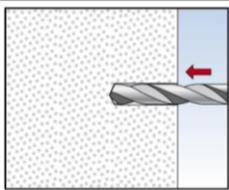
1: Bohrloch erstellen. Andere Methoden zur Bohrerstellung wie z.B. Stößeln sind erlaubt. Wenn der Porenbeton mit harten nichttragenden Schichten wie z.B. Fliesen beplankt ist, müssen diese mit dem Außendurchmesser  $\varnothing D$  vorgebohrt werden.
