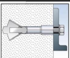
5a: Optional Anziehen des Befestigungsmittels mit einem Drehmoment  $T_{\max} \leq 3 \text{ Nm}$ . Der Anker kann dabei abhängig von der Druckfestigkeit des Porenbetons gegen das Anbauteil gezogen werden.
