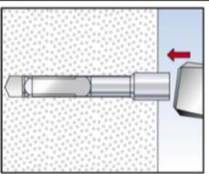
2: Einschlagen des Dübels bündig zur Porenbetonoberfläche.
