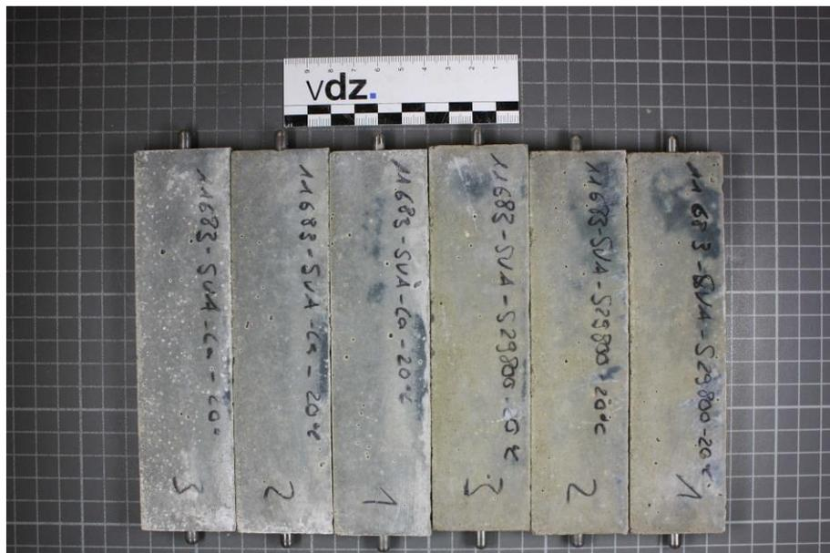
Bild A1: Probekörper aus CEM III/A 52,5 N-SR "ENCI Rotterdam" nach 180 Tagen; Lagerung: 20 °C in  $\text{Ca(OH)}_2$ -Lösung (3 linken Probekörper) und  $\text{Na}_2\text{O}_4$ -Lösung (3 rechten Probekörper)
