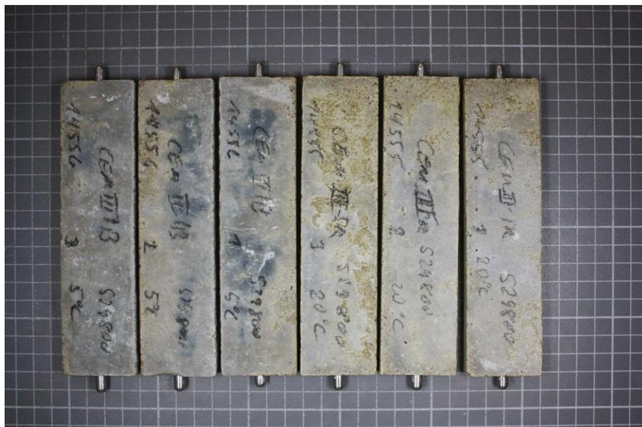
Bild A3: Probekörper mit CEM III/B 42,5 N-LH/SR nach 180 Tagen;
