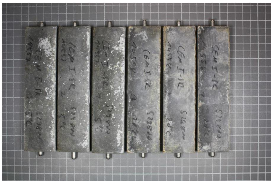
Bild A4: Probekörper mit CEM I 42,5 R-SR3 nach 180 Tagen;
