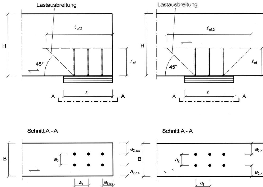
Abbildung A.3.1: Verstärktes Endauflager (links) und verstärktes Zwischenaufleger (rechts)
