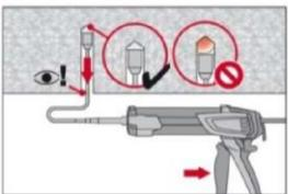
Überkopfanwendung und/oder Montage bei Verankerungstiefen von  $h_{ef} > 250\text{mm}$ . Das Injizieren des Mörtels bei Überkopfanwendung ist nur mit Hilfe von Stauzapfen und Verlängerungen möglich.
