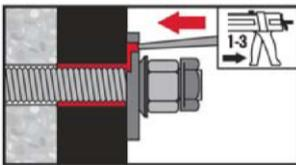
Ringspalt zwischen Befestigungsteil und Ankerstange mit dem Hilti Injektionsmörtel HIT-HY 200-R mit ca. 1 bis 3 Hieben verfüllen.
