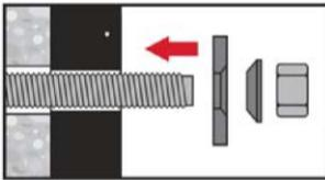
Kugelige Seite der Kugelscheibe zur Verfüllscheibe orientieren. Verfüllscheibe, Kugelscheibe und Mutter auf Gewinde montieren.
