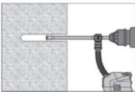
Die Bohrlocherstellung bis zur erforderlichen Setztiefe erfolgt drehschlagend mit einem Hilti Hohlbohrer TE-CD oder TE-YD in Kombination mit einem Hilti Entstaubern VC 20/40 (-Y) (Ansaugmenge  $\geq 57$  l/s) mit eingeschalteter automatischer Filterabreinigung zu verwenden. Dieses Bohrsystem beseitigt bei Anwendung gemäß der Gebrauchsanweisung des Hohlbohrers das Bohrmehl und reinigt das Bohrloch während des Bohrvorgangs. Für Hohlbohrer TE-CD Größe 12 und 14 siehe Tabelle B8.
