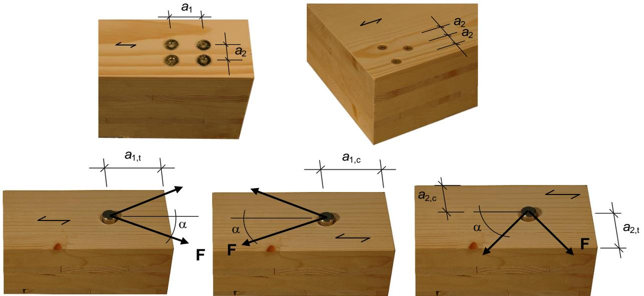
Abbildung A.2.1: Definition der Mindestabstände in der Seitenfläche
