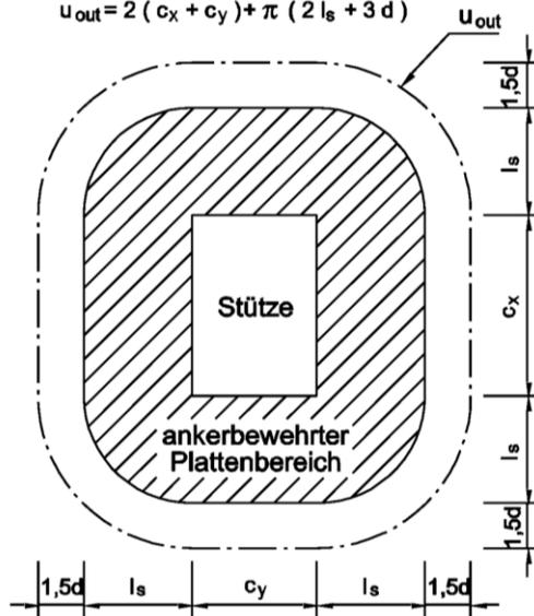
a) Belastete Fläche (Stütze) liegt weniger als 6 d von Plattenöffnungen entfernt
