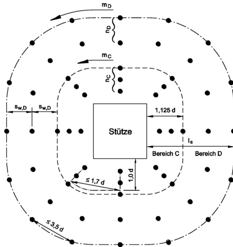
$m_C$  Anzahl der Elementreihen um die Stütze im Bereich C
