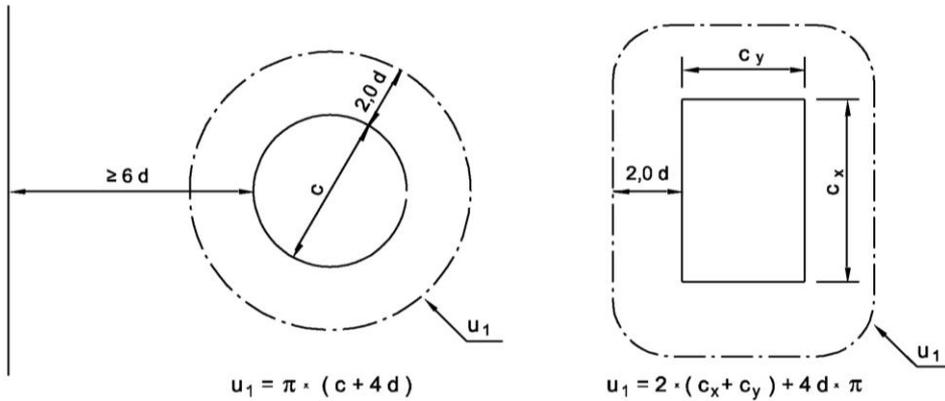
b) Belastete Fläche (Stütze) liegt weniger als  $6d$  von Plattenöffnungen (Ausparungen) entfernt
