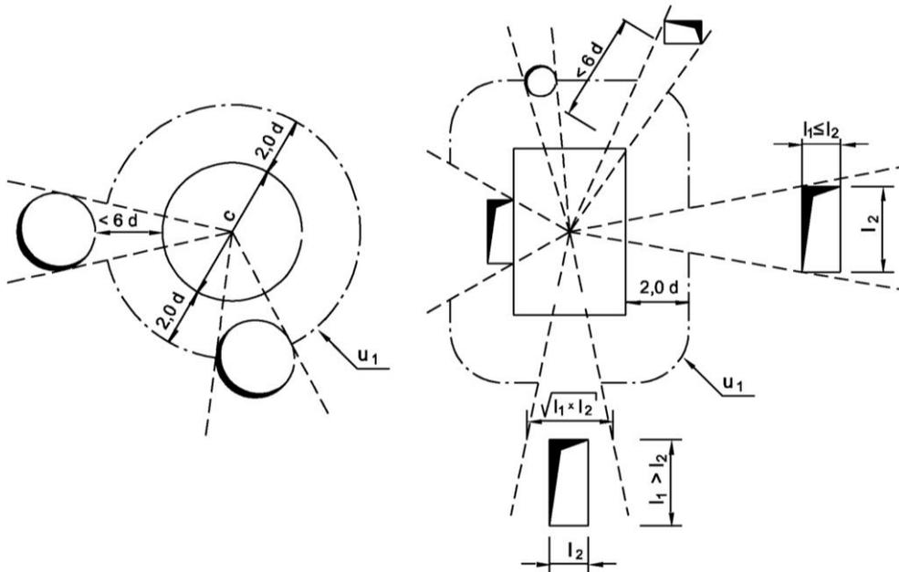
c) Belastete Fläche (Stütze) liegt weniger als 6 d von freien Rändern entfernt
