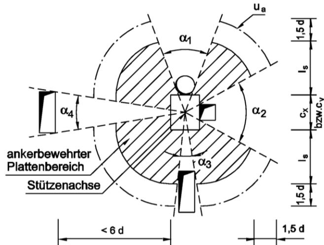
b) Belastete Fläche (Stütze) liegt weniger als 6 d von freien Rändern entfernt
