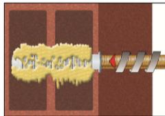
7. Vor dem Einsetzen der Ankerstange ist die Verankerungstiefe auf der Ankerstange zu markieren. Befestigungselement mit leichten Drehbewegungen bis zur festgelegten Setztiefe eindrücken. Die Ankerstange muss schmutz-, fett-, und ölfrei sein.
