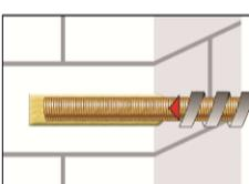
6. Vor dem Einsetzen der Ankerstange ist die Verankerungstiefe auf der Ankerstange zu markieren. Befestigungselement mit leichten Drehbewegungen bis zur festgelegten Setztiefe eindrücken. Die Ankerstange muss schmutz-, fett-, und ölfrei sein.
