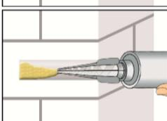
5. Das Bohrloch vom Grund her zu mindestens 2/3 mit Mörtel füllen. Langsames Zurückziehen des Statikmischer aus dem Bohrloch verhindert die Bildung von Luftporen. Die temperaturrelevanten Verarbeitungszeiten (Tabelle B4 und B5) sind zu beachten.
