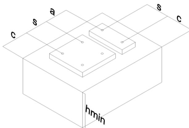
Befestigungspunkte mit Achsabständen  $a \leq s_{cr,N}$  gelten als Gruppen mit einer maximalen charakteristischen Zugtragfähigkeit  $N_{Rk,p}$  nach Tabelle 17 – Tabelle 27. Für  $a > s_{cr,N}$  gelten die Dübel als Einzeldübel, von denen jeder eine charakteristische Zugtragfähigkeit  $N_{Rk,p}$  nach Tabelle 17 – Tabelle 27 hat.
