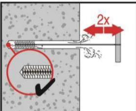
2-mal mit Stahlbürste in passender Größe (siehe Tabelle B5 bis B10) bürsten. Stahlbürste Hilti HIT-RB mit einer Drehbewegung in das Bohrloch bis zum Bohrlochgrund einführen und wieder herausziehen (falls notwendig mit Verlängerung).
