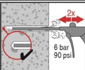
Bohrloch erneut mit der Hilti Handpumpe oder Druckluft 2-mal ausblasen, bis die rückströmende Luft staubfrei ist.
