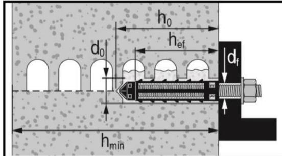
**Bild A2:** Lochstein und Vollstein mit Gewindestange, HIT-V-... und zwei Siebhülsen HIT-SC für große Verankerungstiefe (siehe Tabelle B6)
