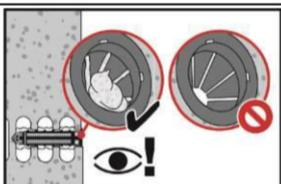
Kontrolle der injizierten Mörtelmenge. Der Mörtel muss aus der Kappe ausgetreten sein.
