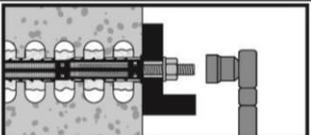
Nach Ablauf der Aushärtezeit  $t_{cure}$  (siehe Tabelle B11 und Tabelle B12) kann der Dübel belastet werden.
