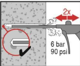
Bohrloch 2-mal vom Bohrlochgrund über die gesamte Länge mit der Hilti Handpumpe (Bohrlochdurchmesser  $d_0 \leq 18$  mm und Bohrlochtiefe bis  $h_0 = 100$  mm) oder ölfreier Druckluft (min. 6 bar bei  $6 \text{ m}^3/\text{h}$ ; Bohrlochtiefe bis  $h_0 = 300$  mm) ausblasen, bis die rückströmende Luft staubfrei ist. Falls notwendig Verlängerung verwenden.
