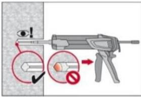
Injizieren des Mörtels vom Bohrlochgrund und während jedes Hubes den Mischer zurückziehen.
