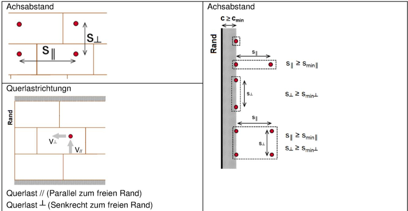
Die charakteristischen Widerstände einer Dübelgruppe werden unter Verwendung von Gruppenfaktoren  $\alpha_g$  gemäß Anhang C3 bis C30, berechnet
