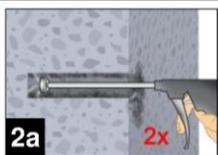
2a. Das Bohrloch vom Bohrlochgrund her 2x vollständig mit Druckluft (min. 6 bar) (Annex B 7) ausblasen, bis die ausströmende Luft staubfrei ist. Bei tiefen Bohrlöchern sind geeignete Verlängerungen zu verwenden.
