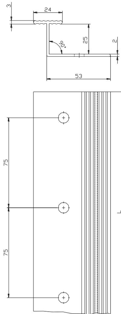
**Vertikales Verbindungsprofil – "PPU Verbindungsleiste PVC" (Maße in mm)**
