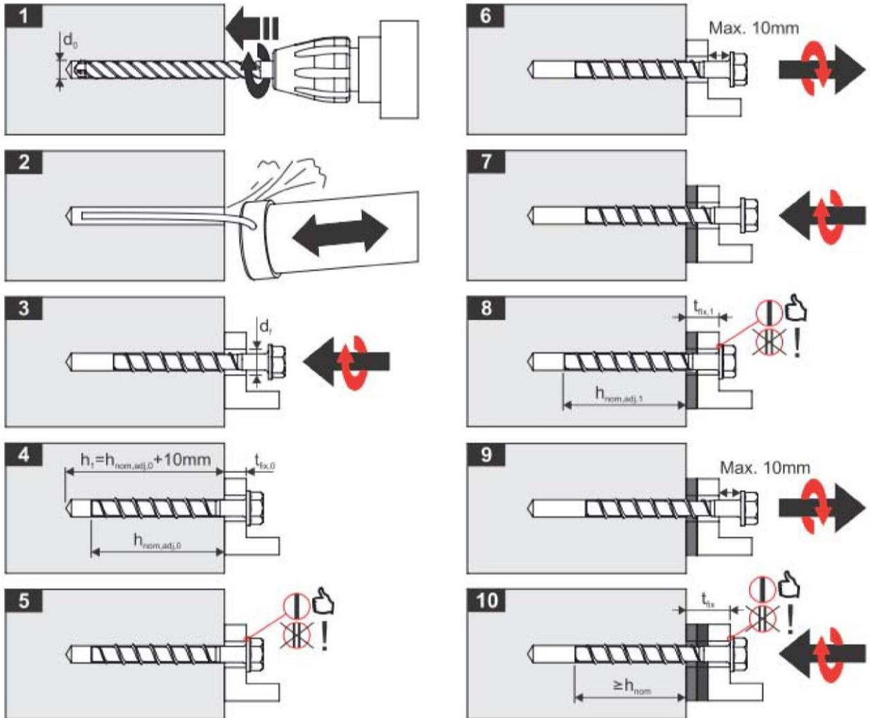
Der Dübel darf maximal zweimal adjustiert werden. Dabei darf der Dübel jeweils maximal um 10 mm zurück geschraubt werden. Die bei der Adjustierung erfolgte Unterfüterung darf insgesamt maximal 10 mm betragen. Die erforderliche Setztiefe  $h_{nom}$  muss nach der Adjustierung noch eingehalten sein.
