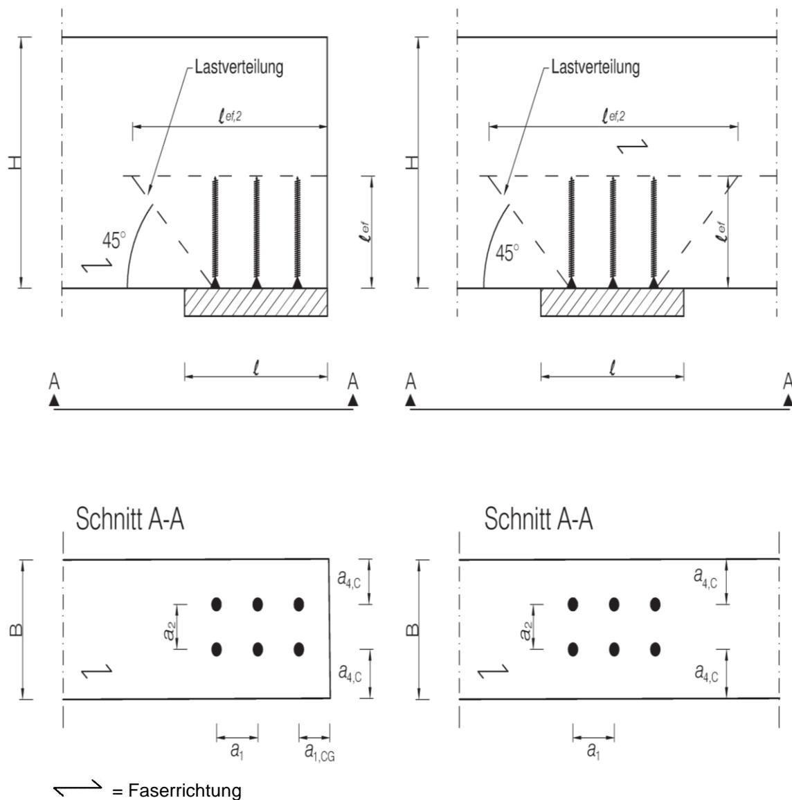
Abbildung A.3.1: Verstärktes Endauflager (links) und verstärktes Zwischenauflager (rechts)
