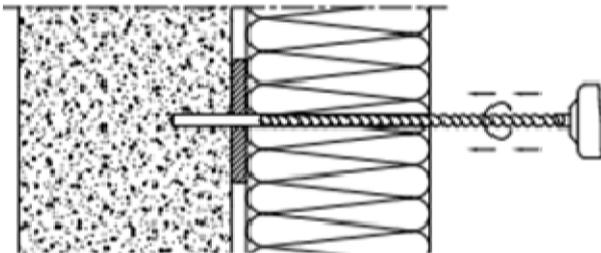
Bohrloch rechtwinklig zur Oberfläche des Untergrundes erstellen.
