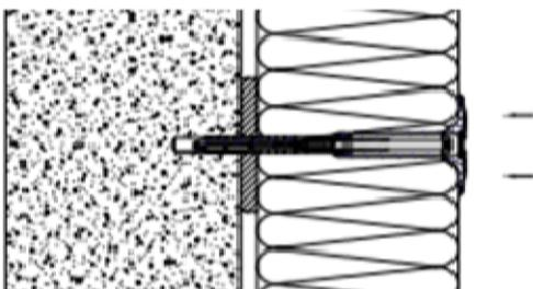
Dübel in das Bohrloch einschieben, bis der Dübelteller bündig auf der Dämmplattenoberfläche aufliegt.
