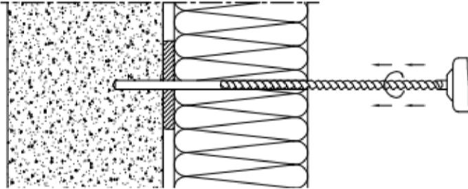
Bohrloch rechtwinklig zur Oberfläche des Untergrundes erstellen.
