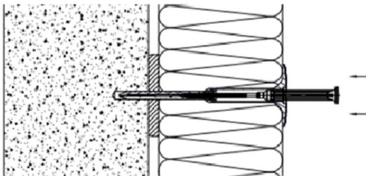
Dübel in das Bohrloch einschieben, bis der Dübelteller bündig auf der Dämmplattenoberfläche aufliegt.
