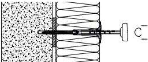
Dübelschraube in den Dübel montieren, bis die Dübelschraube im Dübelteller aufliegt.
