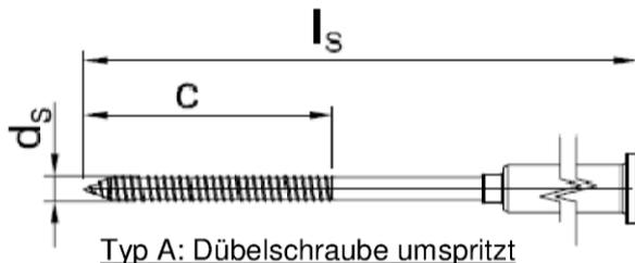
Typ A: Dübelschraube umspritzt
