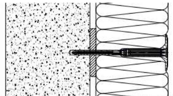
Einbauzustand ejothem N (Typ A+B), oberflächenbündig.
