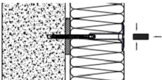
EPS Stopfen bündig zur Telleroberfläche des Dübels montieren.
