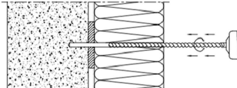
Bohrloch rechtwinklig zur Oberfläche des Untergrundes erstellen.
