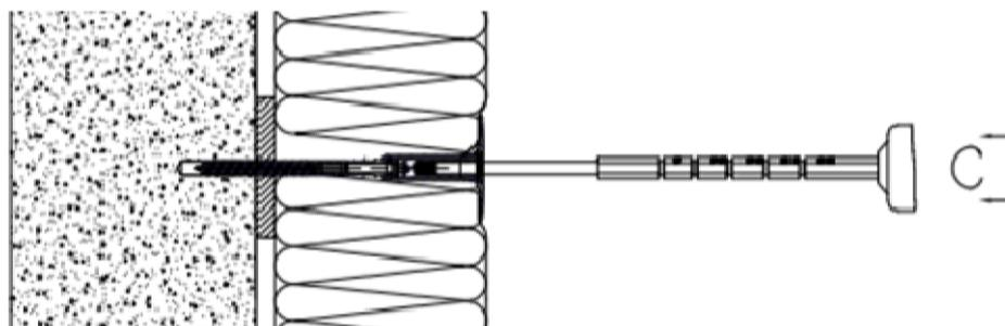
Dübelschraube in den Dübel montieren, bis die Dübelschraube im Dübelteller aufliegt.
