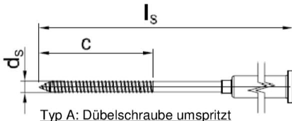
Typ A: Dübelschraube umspritzt
