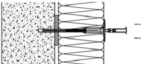
Dübel in das Bohrloch einschieben, bis der Dübelteller bündig auf der Dämmplattenoberfläche aufliegt.
