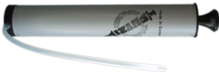
MAC - Handpumpe (Volumen 750 ml) Bohrerdurchmesser ( d_0 ): 10 mm bis 20 mm Bohrlochtiefe ( h_0 ): < 10 d_s Nur im ungerissenen Beton
