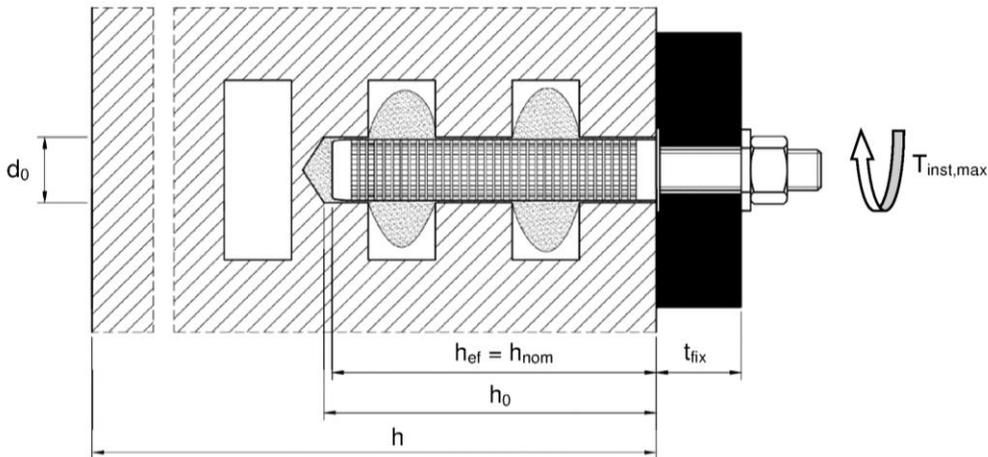
**Installation in Vollstein: Ankerstange (optional mit Innengewinde) mit Siebhülse**
