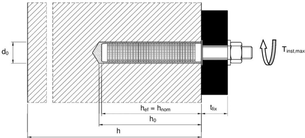
**Installation in Vollstein: Ankerstange (optional mit Innengewinde) ohne Siebhülse**
