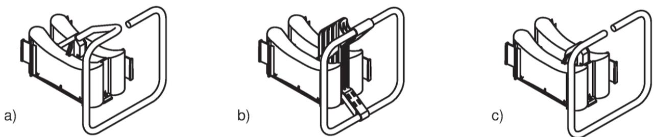
Abb. 31 Betondrucklager mit Sonderbügel
