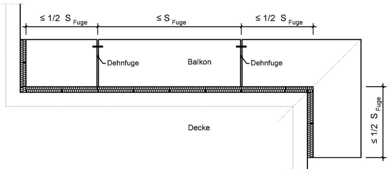
Abb. 13 Einbausituation mit Dehnfugen
