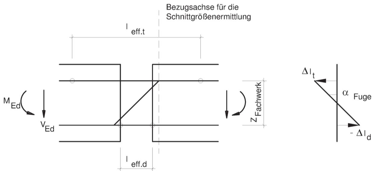
Abb. 37 Modell für die Ermittlung der Biegeverformung in der Fuge
