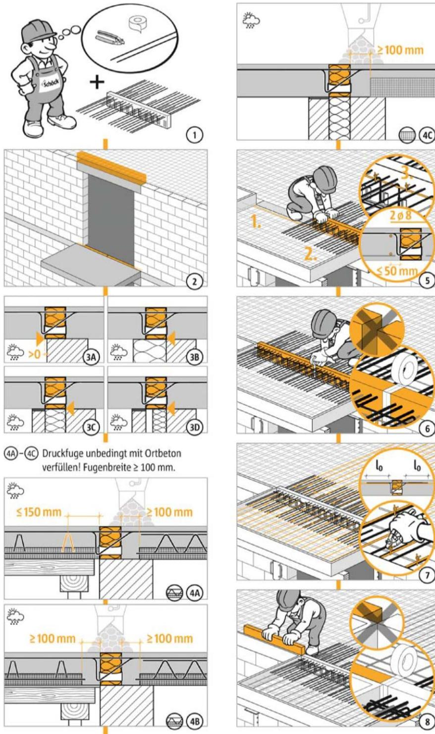
4A)–4C) Druckfuge unbedingt mit Ort beton
