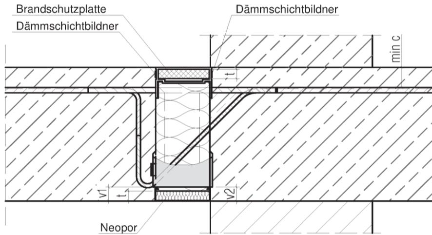
Abb. 23 Schöck Isokorb<sup>®</sup> Typ K und Typ KF mit CCE
