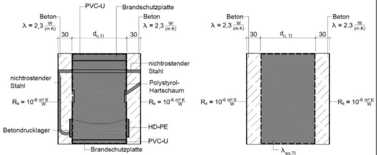
Abb. 25 Querschnitt der Konstruktion zur Bestimmung des äquivalenten Wärmedurchlasswiderstandes  $R_{eq,TI}$  sowie vereinfachtes Modell mit  $\lambda_{eq,TI}$
