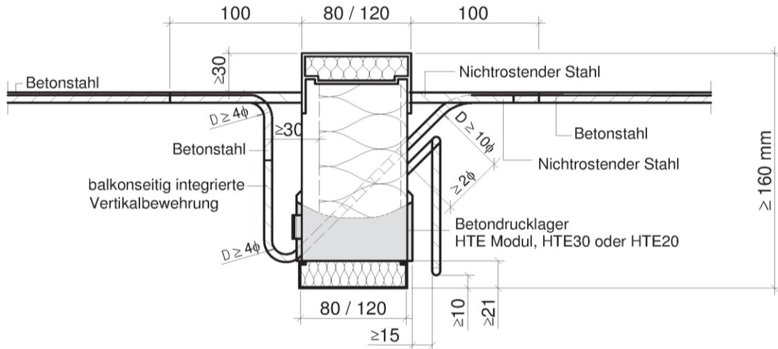
Abb. 29 Schöck Isokorb Typ K<sup>1)</sup> mit integrierter Vertikalbewehrung gem. Abschn. D.1.1 und Sonderbügel
