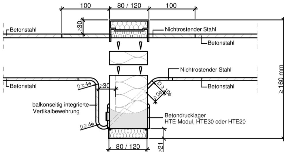
Abb. 16 Schöck Isokorb® Typ KF (Variante mehrteilig) mit CCE
