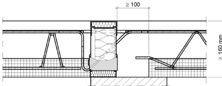
Abb. 19 Schöck Isokorb<sup>®</sup> Typ K mit CCE und Elementplatten
