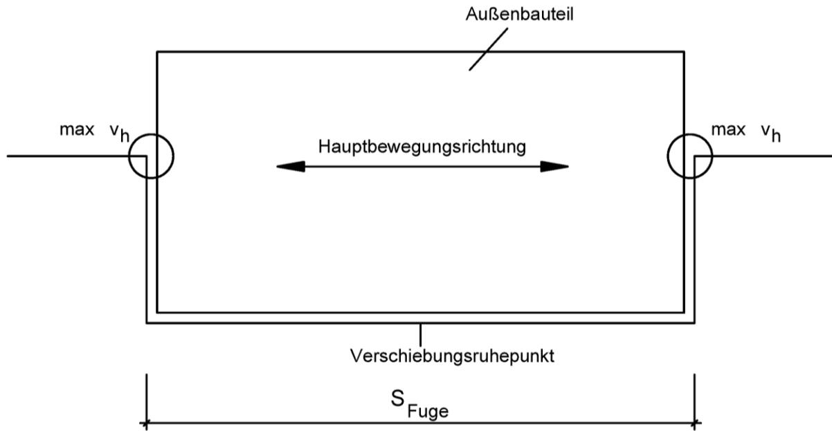
Abb. 12 Einbausituation mit Lagerung zwischen gegenüberliegenden Rändern
