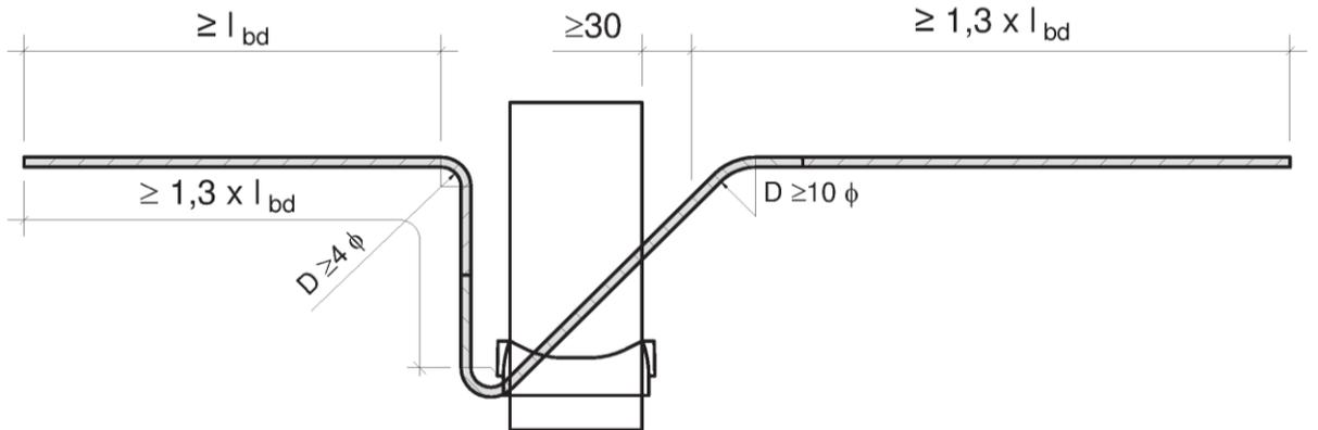
Abb. 32 Schöck Isokorb® Typ K / KF (Variante mehrteilig)
