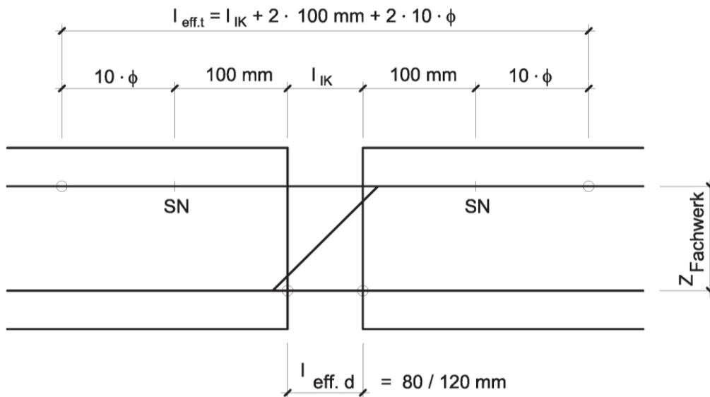
Abb. 39  $l_{\text{eff}}$  für nichtrostenden glatten Stabstahl Fkl.
