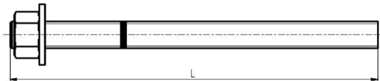
Markierung der Verankerungstiefe
