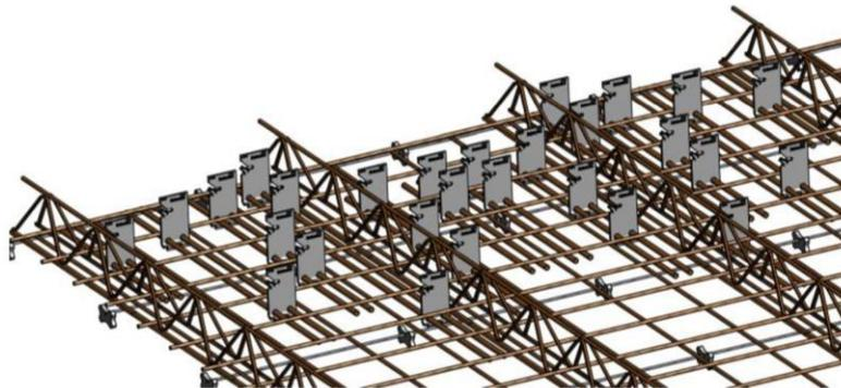
Die Lagesicherung kann durch Federklemmen oder Bindedraht erfolgen.
