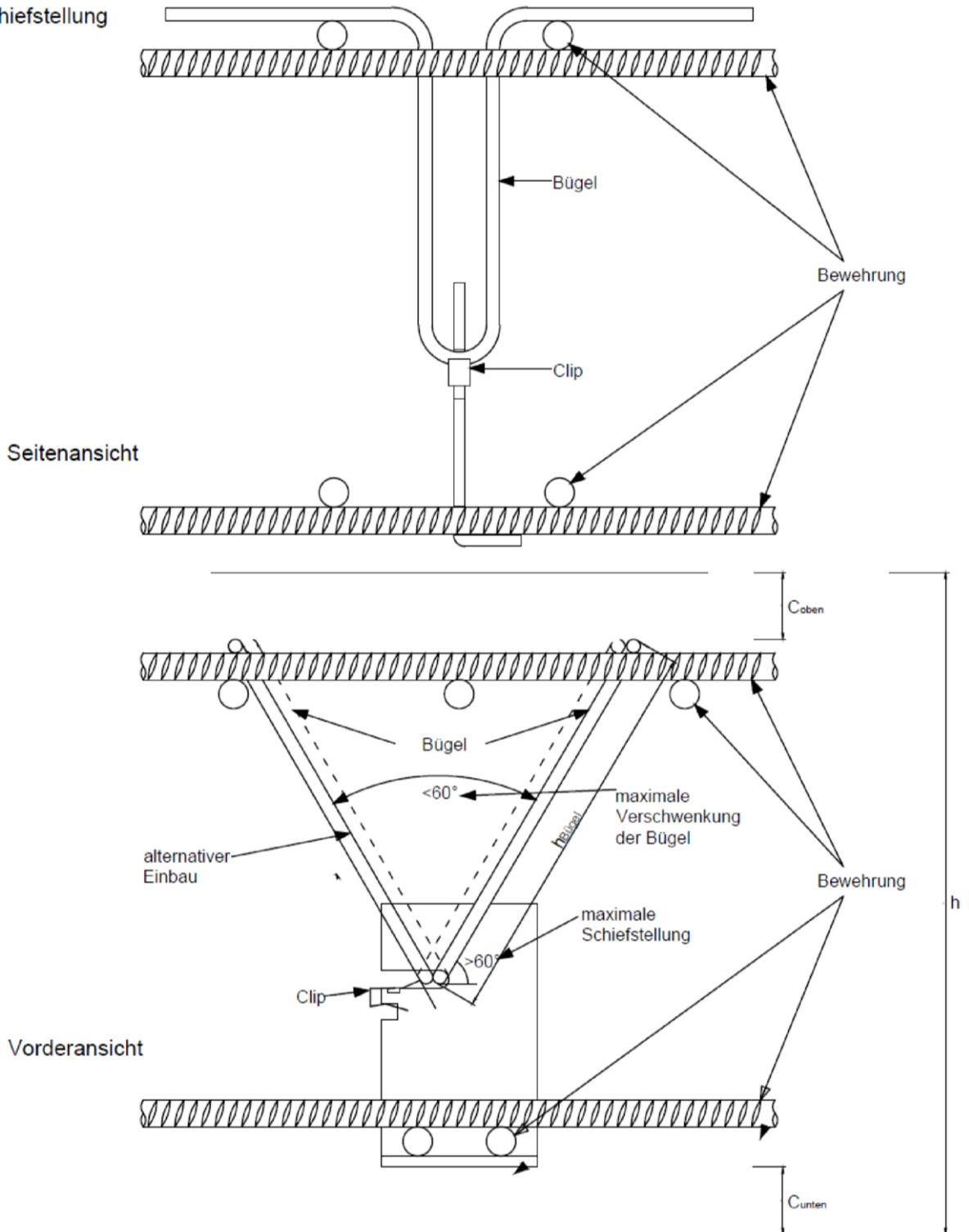
$h_{\text{Bügel}}$  in Abhängigkeit von der Plattenhöhe und der Betonüberdeckung siehe Anhang A3/A4.
