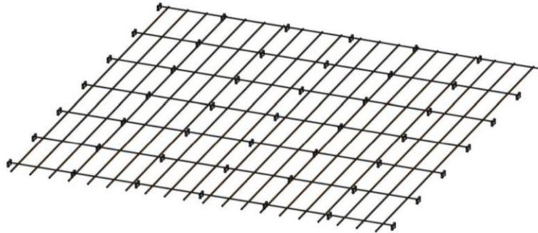
**3. Montage der Linienelemente durch einfaches Auflegen parallel zur Bewehrungsrichtung und den Gitterträgern**
