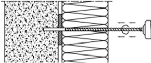
Bohrloch rechtwinklig zur Oberfläche des Untergrundes erstellen.
