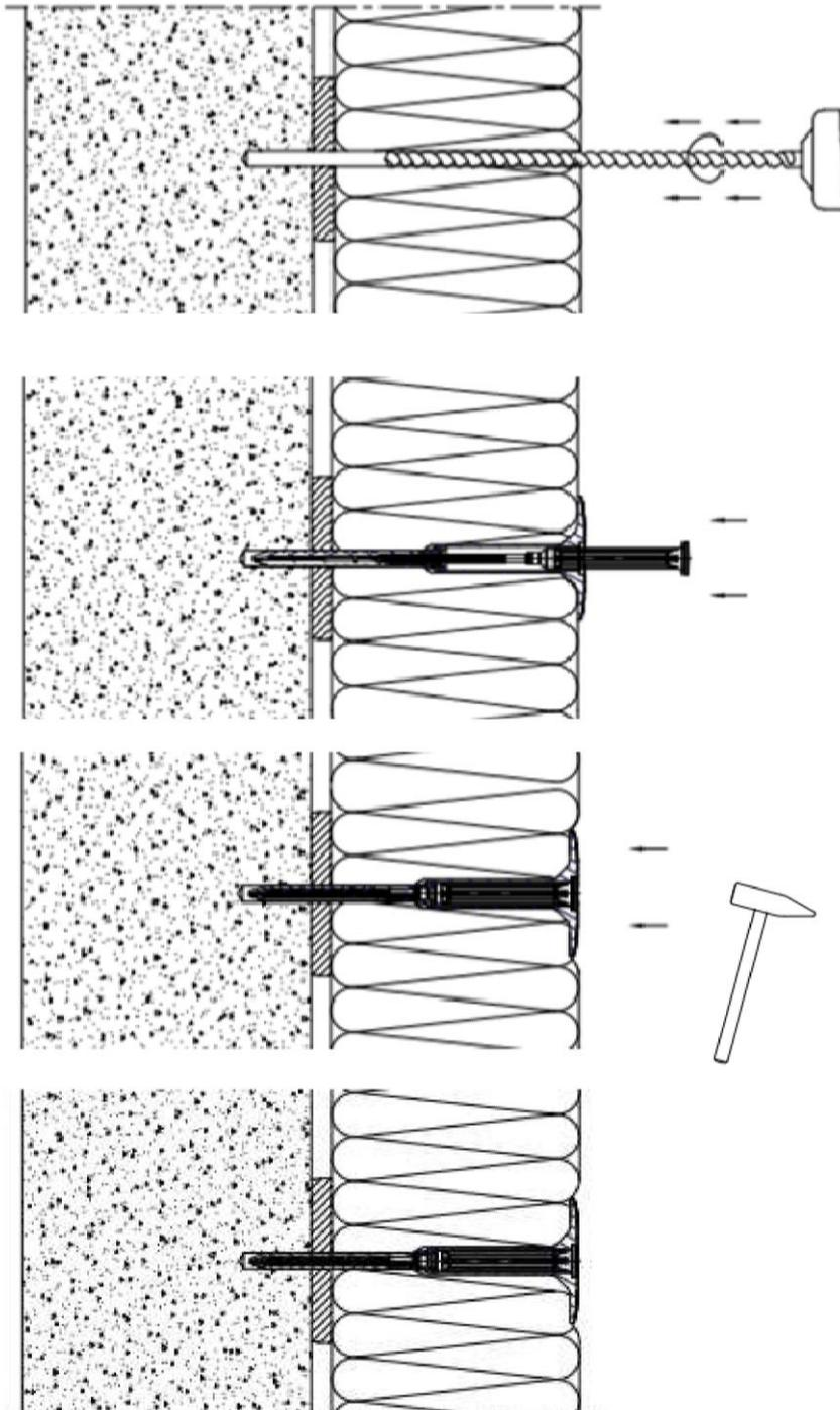
Bohrloch rechtwinklig zur Oberfläche des Untergrundes erstellen.
