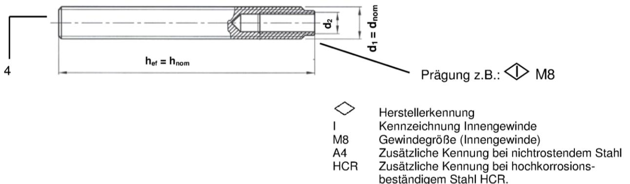
Injektionssystem HB-VMU plus für Mauerwerk
