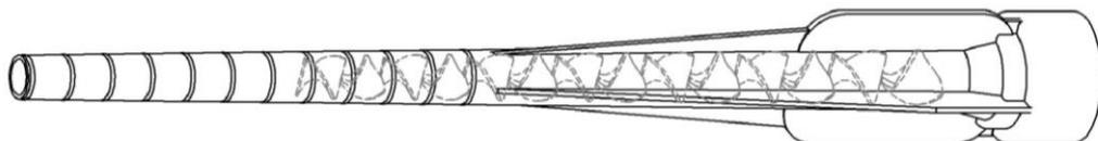
Injektionssystem HB-VMU plus für Mauerwerk
