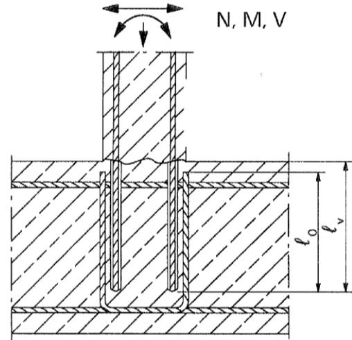
**Bild A3:** Endverankerung von Platten oder Balken
