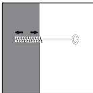
2e. Bohrloch mit geeigneter Drahtbürste gem. Tabelle B5 (minimaler Bürstendurchmesser  $d_{b,min}$  ist einzuhalten und zu überprüfen) 2x mittels eines Akkuschaubers oder einer Bohrmaschine ausbürsten. Bei tiefen Bohrlöchern ist eine geeignete Bürstenverlängerung zu benutzen.
