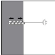
2b. Bohrloch mit geeigneter Drahtbürste gem. Tabelle B5 (minimaler Bürstendurchmesser  $d_{b,min}$  ist einzuhalten und zu überprüfen) 2x mittels eines Akkuschaubers oder Bohrmaschine ausbürsten. Bei tiefen Bohrlöchern Bürstenverlängerung benutzen (Tabelle B5).
