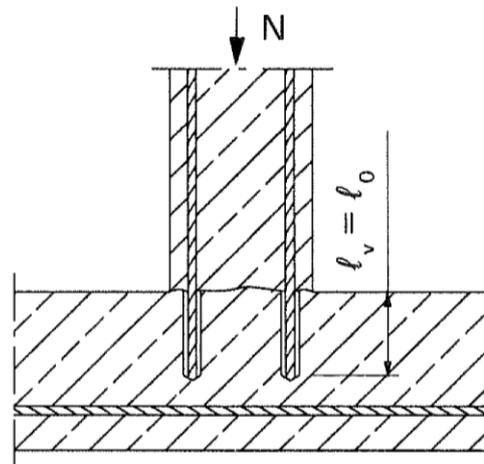
**Bild A5:** Verankerung von Bewehrung zur Deckung der Zugkraftlinien
