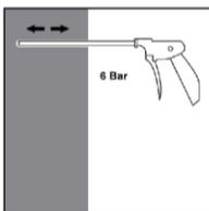
2f. Anschließend das Bohrloch erneut vom Bohrlochgrund her 2x vollständig mit Druckluft (min. 6 bar) und geeigneter Ausblasdüse gem. Tabelle B5 ausblasen. Bei tiefen Bohrlöchern sind geeignete Verlängerungen zu verwenden.
