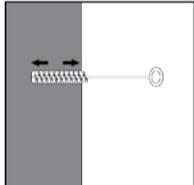
2c. Anschließend das Bohrloch erneut vom Bohrlochgrund her 2x vollständig mit Druckluft (min. 6 bar) oder Handpumpe ausblasen. Bei tiefen Bohrlöchern sind geeignete Verlängerungen zu verwenden.
