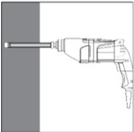
1. Bohrloch mit dem Bohrdurchmesser gemäß Tabelle B5 und der Bohrtiefe entsprechend des gewählten Bewehrungs Eisens mit Hammerbohrer (HD), Druckluftbohrer (CD) oder Diamantbohrer (DD) in den Untergrund bohren. Bei Fehlbohrungen ist das Bohrloch zu vermörteln.
