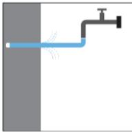
2a. Mit Wasser ausspülen, bis klares Wasser aus dem Bohrloch austritt.
