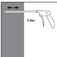
2d. Das Bohrloch vom Bohrlochgrund her 2x vollständig mit Druckluft (min. 6 bar) und geeigneter Ausblasdüse gem. Tabelle B5 ausblasen. Bei tiefen Bohrlöchern sind geeignete Verlängerungen zu verwenden.
