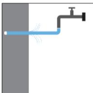
2c. Wiederholt mit Wasser ausspülen, bis klares Wasser aus dem Bohrloch austritt.
