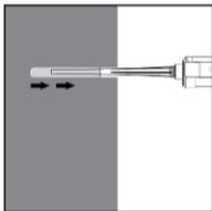
6. Gereinigtes Bohrloch vom Bohrlochgrund her ca. zu 2/3 mit Verbundmörtel befüllen. Langsames Zurückziehen des Statikmischers aus dem Bohrloch verhindert die Bildung von Lufteinschlüssen. Für Setztiefen größer 190 mm passende Mischerverlängerung verwenden.
