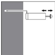
2a. Das Bohrloch vom Bohrlochgrund her 2x vollständig mit Druckluft (min. 6 bar) oder Handpumpe ausblasen. Bei tiefen Bohrlöchern sind geeignete Verlängerungen zu verwenden.
