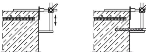
Für Bohrtiefen  $l_v > 20$  cm Bohrhilfe verwenden.
