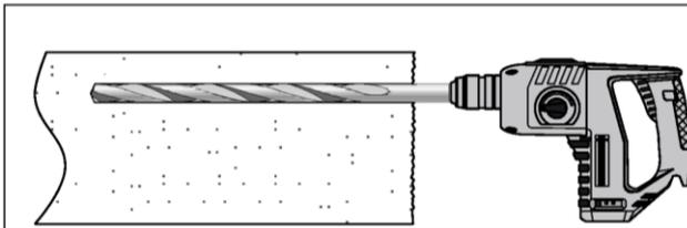
Das Bohrloch mit einem Hammer- oder Pressluftbohrer bis zur erforderlichen Setztiefe erstellen.
