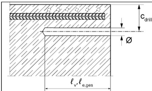
Betonüberdeckung  $c$  messen und prüfen ( $c_{drill} = c + \phi / 2$ ).
