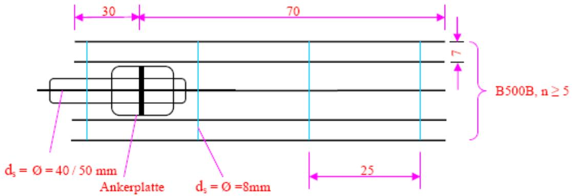
**Bild 5. Beispiel für die Bewehrung einer Stütze**
