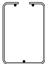
Bild 4: Bügelkorb für \Delta\sigma_{Rsk} = 175 \text{ N/mm}^2 (bei N=1\cdot 10^6 Lastw.)
