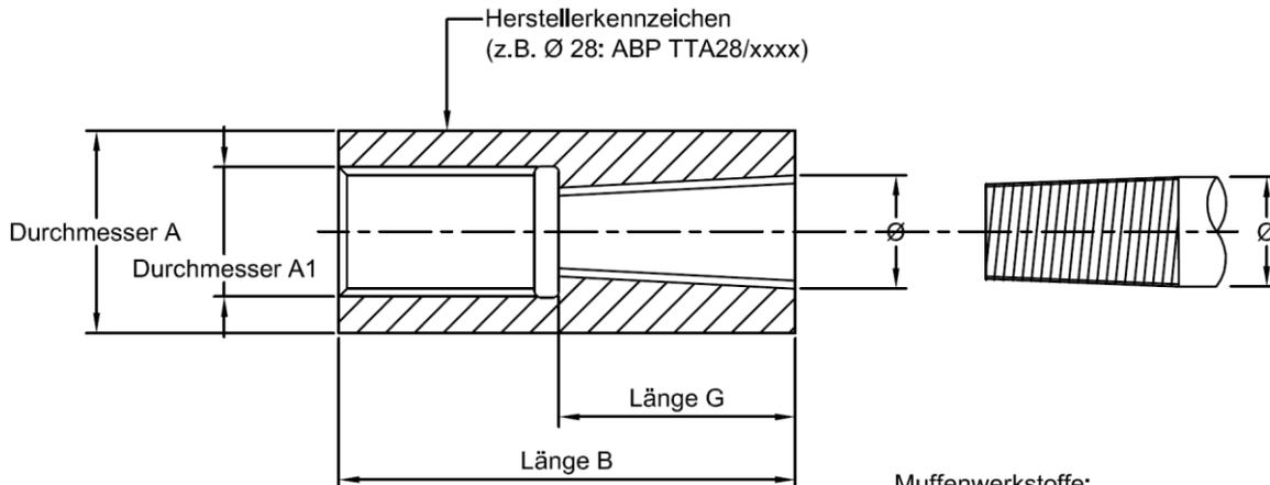
Muffe werkseitig montiert
