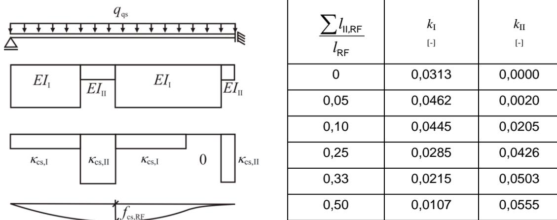
**Bild 3:** Hilfswerte  $k_I$  und  $k_{II}$  zur Bestimmung von  $f_{cs,RF}$  nach DAfStb Heft 533
