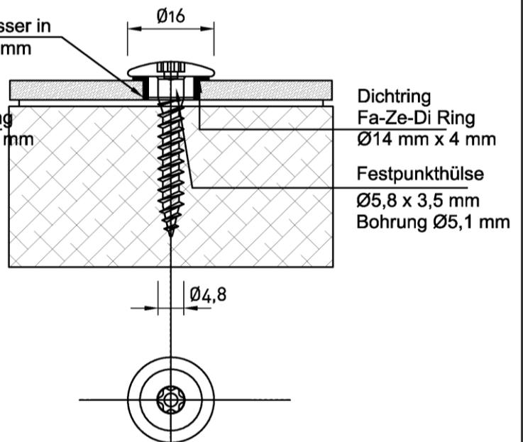
Dichtring Fa-Ze-Di Ø14 mm x 4 mm
