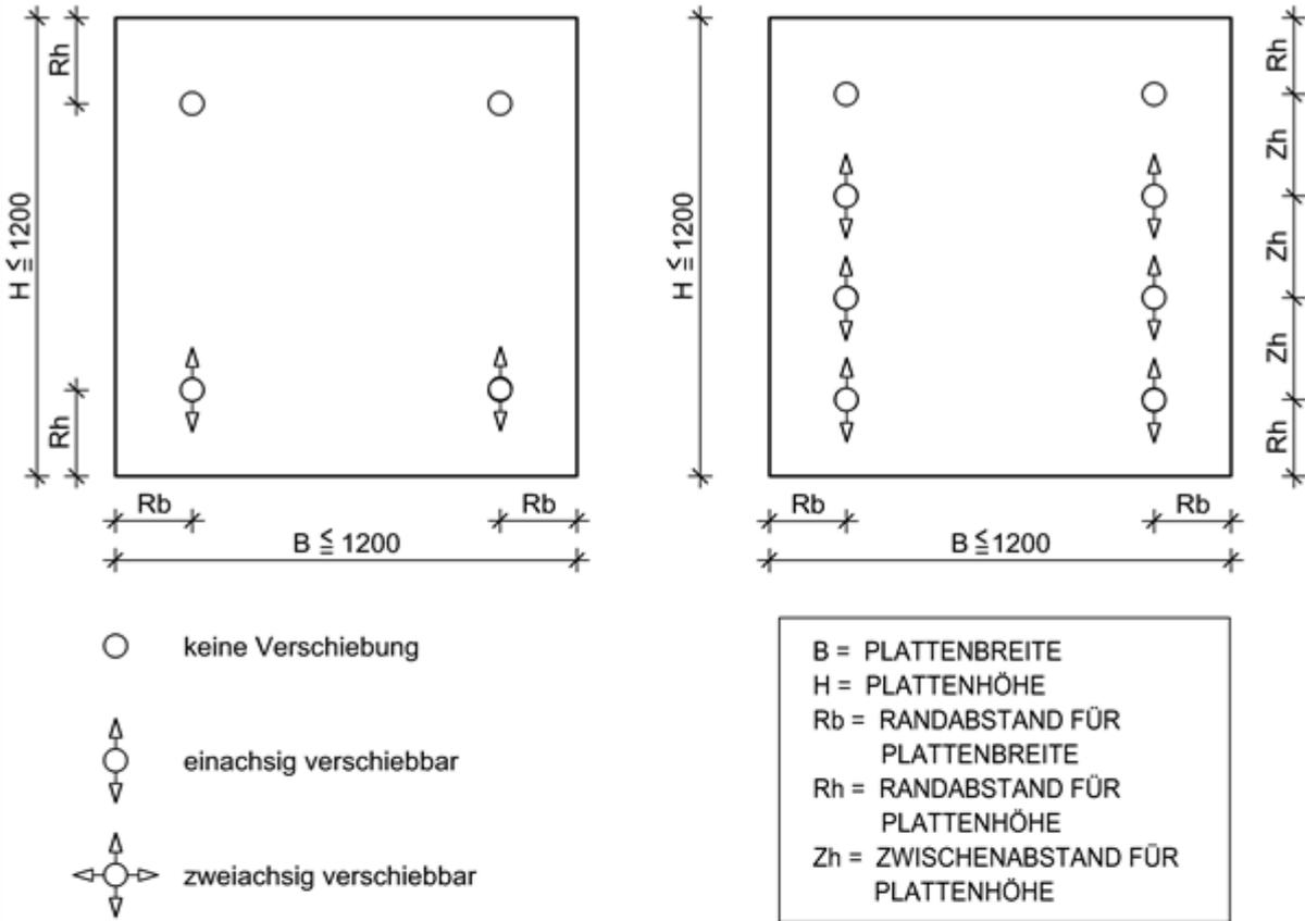
**VERBINDUNG PLATTENTRAGPROFIL MIT DER PLATTE UND UNTERKONSTRUKTION
