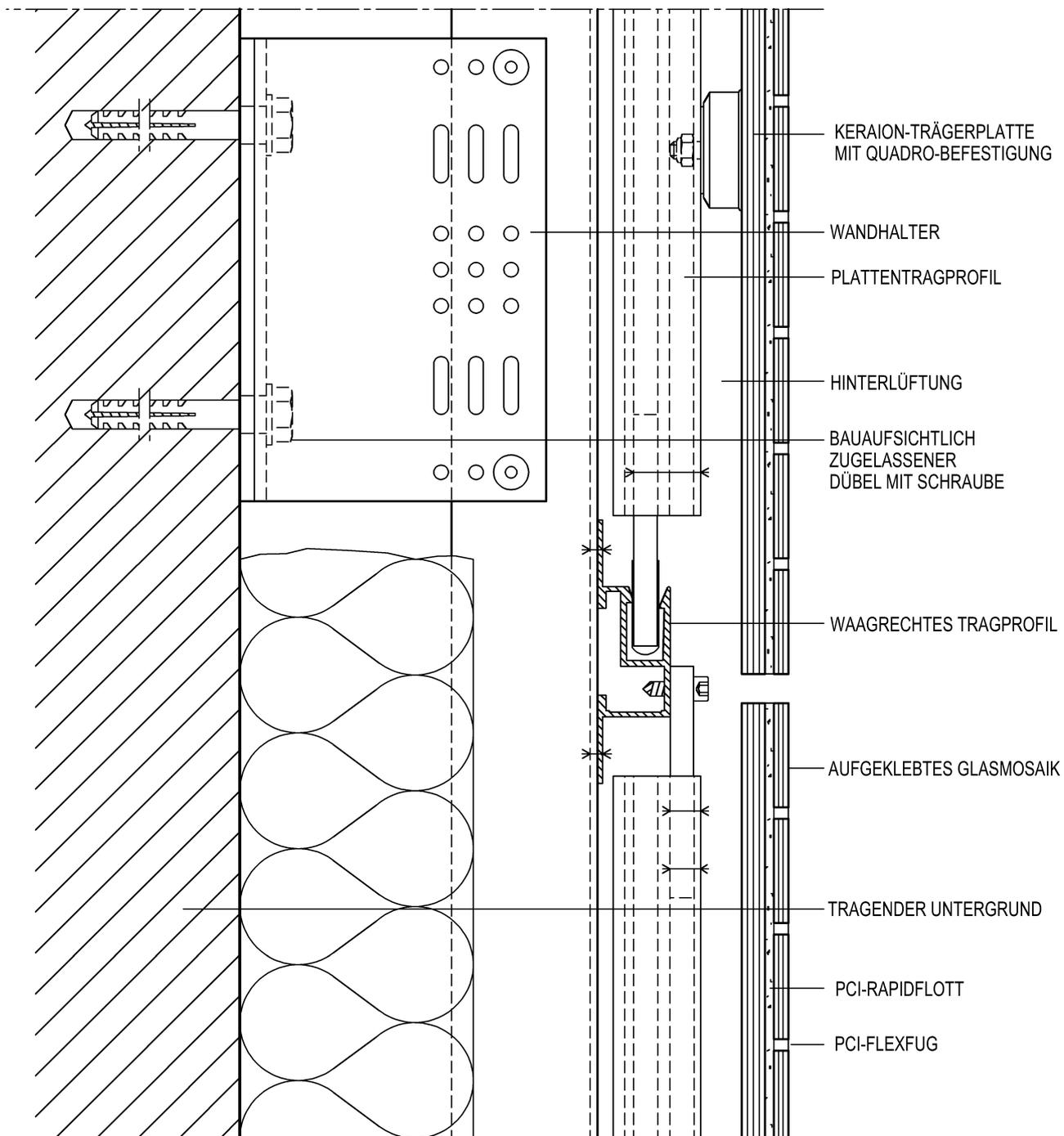
Vorgehängte, hinterlüftete Außenwandbekleidung mit Fassadenplatten "KerAion-Quadro" und "KerAion-Plus" mit Plattentragprofilen
