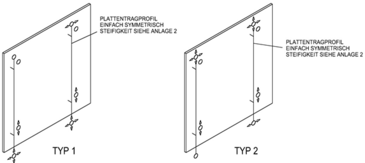
Vorgehängte, hinterlüftete Außenwandbekleidung mit Fassadenplatten "KerAion-Quadro" und "KerAion-Plus" mit Plattentragprofilen
