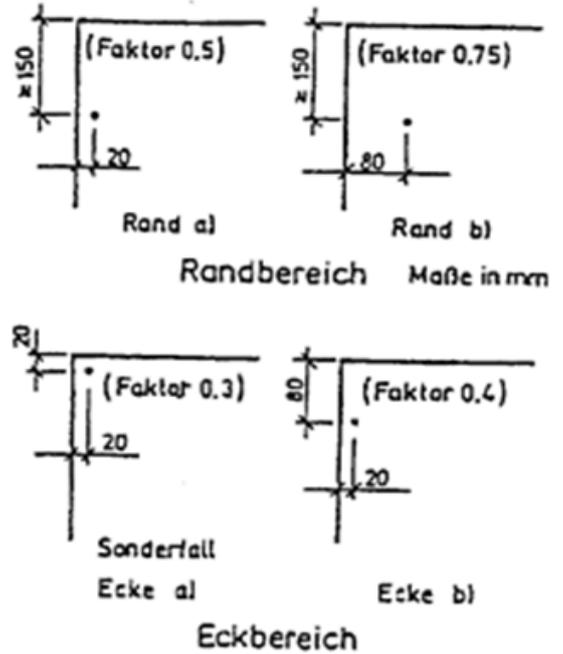
Bemessungswerte des Bauteilwiderstandes für Zugbeanspruchungen  $F_{Z,Rd}$  [N] bei der Befestigung mit Blindnieten und Montageschrauben nach Abschnitt 2.2.2 unter Windeinwirkung
