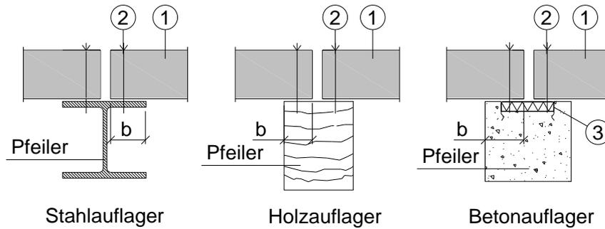
Endauflagerbreite  $b \geq 40 \text{ mm}$
