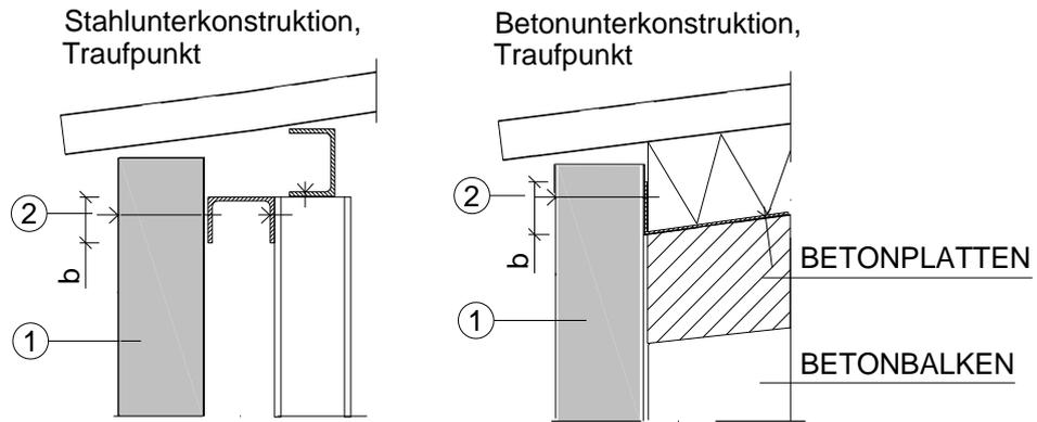
Endauflagerbreite  $b \geq 40 \text{ mm}$
