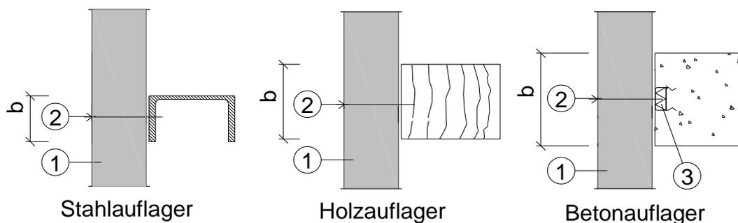
Zwischenauflegerbreite  $b \geq 60 \text{ mm}$
