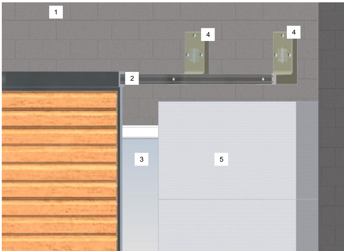
Darstellung 1: Beispiel Einbauzustand Schiebeladen – stirnseitige Montage
