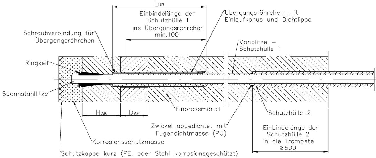
Ausbildung des Korrosionsschutzes bei langen (nachspannbar) und kurzen Litzenüberständen
