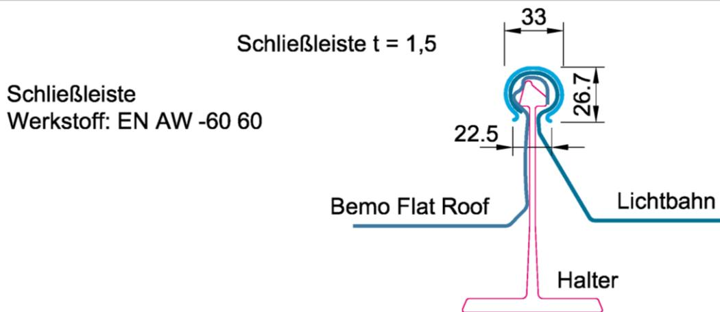
BEMO-FLAT-ROOF Stehfalprofilssystem aus Aluminium
