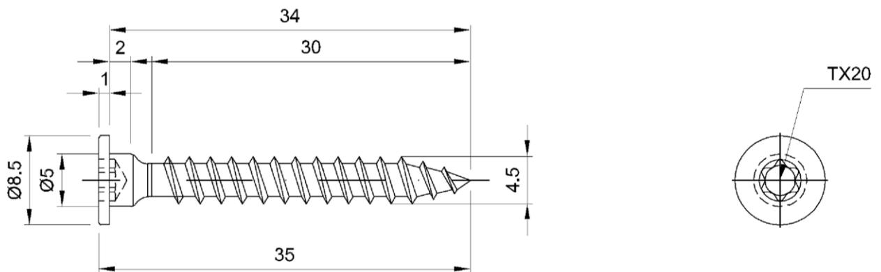
Befestigungssystem für das Fassadensystem RAICO THERM+ H-V
