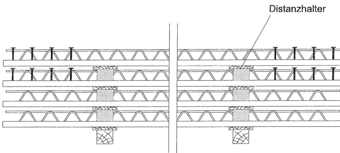
Beim Lagern und Transportieren von Elementdecken sind die Schöck BOLE V Bolzen zu beachten, die aufgrund ihrer Höhe über die Gitterträger hinausragen. Die zur Auflagerung der Elementdecken erforderlichen Distanzhalter sind entsprechend zu erhöhen.
