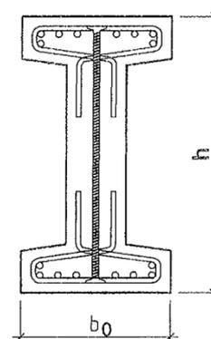
Abstände  $S_{L, BOLE V}$  der Schöck BOLE V Bolzen in Richtung der Biegebeanspruchung nach Tabelle 1. Bei Balken mit  $h < 20$  cm und  $V_{Ed} < 0,3V_{Rd,max}$  braucht der Abstand nicht kleiner als 15 cm zu sein.
