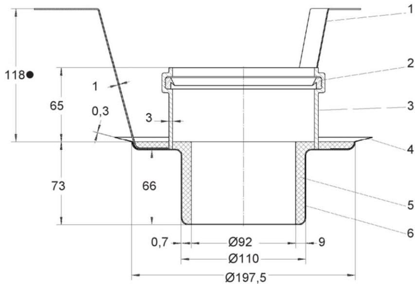
● = für Einbau in Decken 150 mm ≤ d ≤ 300mm
