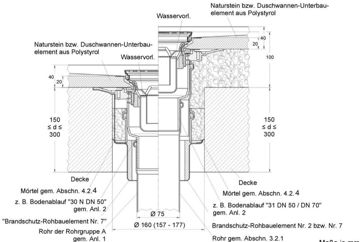
Rohrabschottung "DALLMER Ablauf mit Brandschutzelement Nr. ..." der Feuerwiderstandsklassen R 120, R 90, R 60 oder R 30 nach DIN 4102-11
