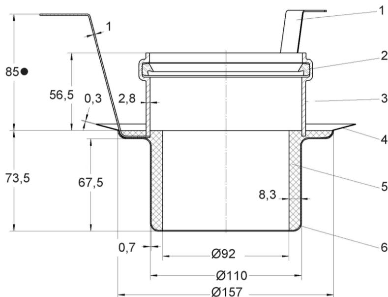
● = für Einbau in Decken  $150 \text{ mm} \leq d \leq 300 \text{ mm}$
