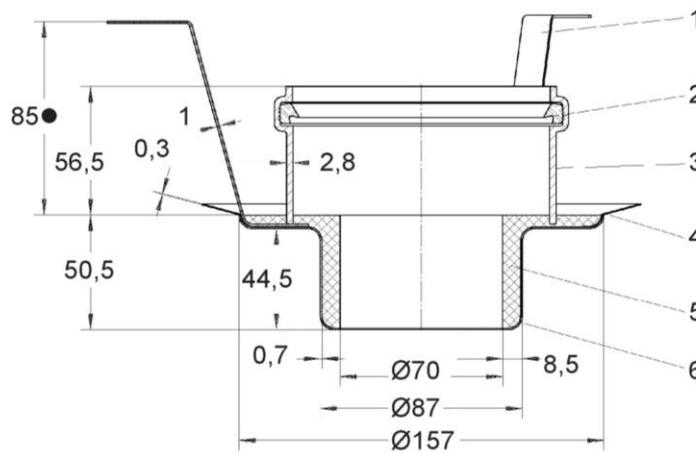
● = für Einbau in Decken 150 mm ≤ d ≤ 300mm
