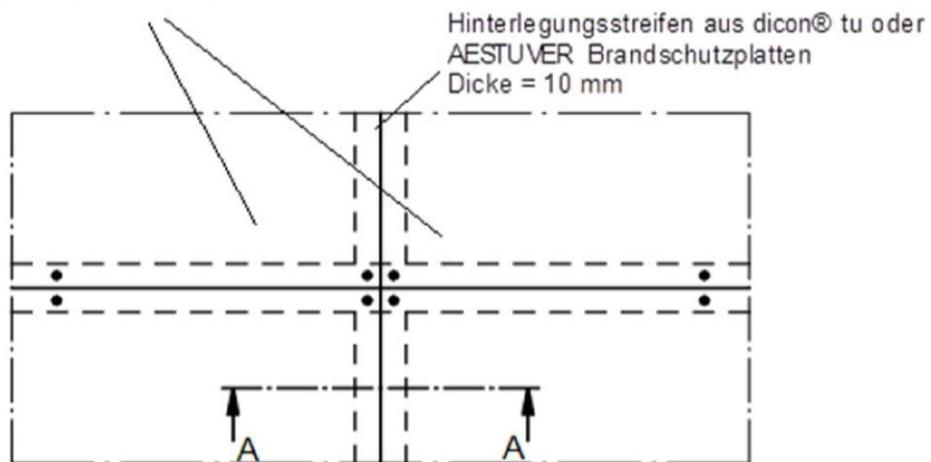
**Einbauzustand: Schnitt A-A**
