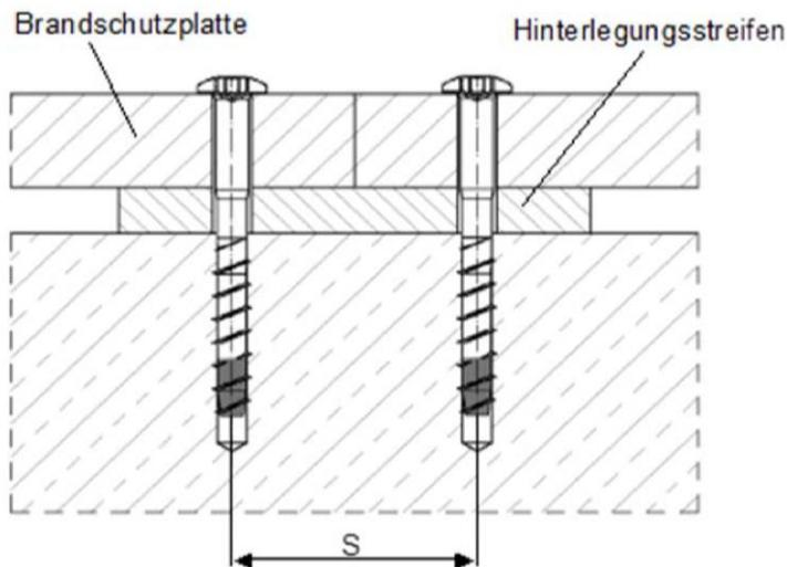
HECO MULTI-MONTI-Schraubanker MMS-P zur Mehrfachbefestigung
