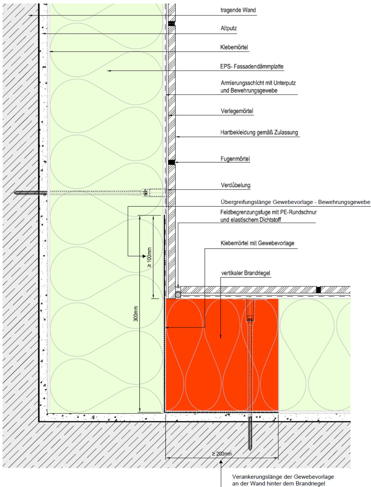
Die Ausführung von Feldbegrenzungsfugen auf einer ebenen Wand bei Brandschutzmaßnahmen nach Abschnitt 4.10.2
