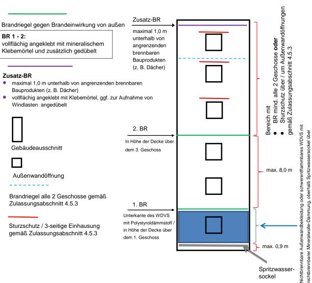
Geländeoberkante, bis zur Höhe der Decke über dem 1. Geschoss, jedoch mind. 3 m nichtbrennbarer Mineralwolle-Dämmung, oberhalb Spritzwassersockel über
