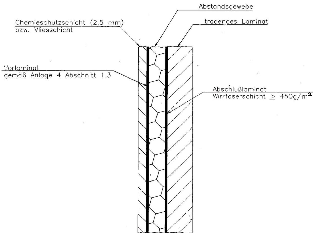
Für die Böden gilt der gleiche Wanddickenaufbau,
