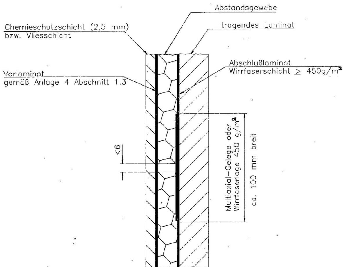
Für die Böden gilt der gleiche Wanddickenaufbau,
