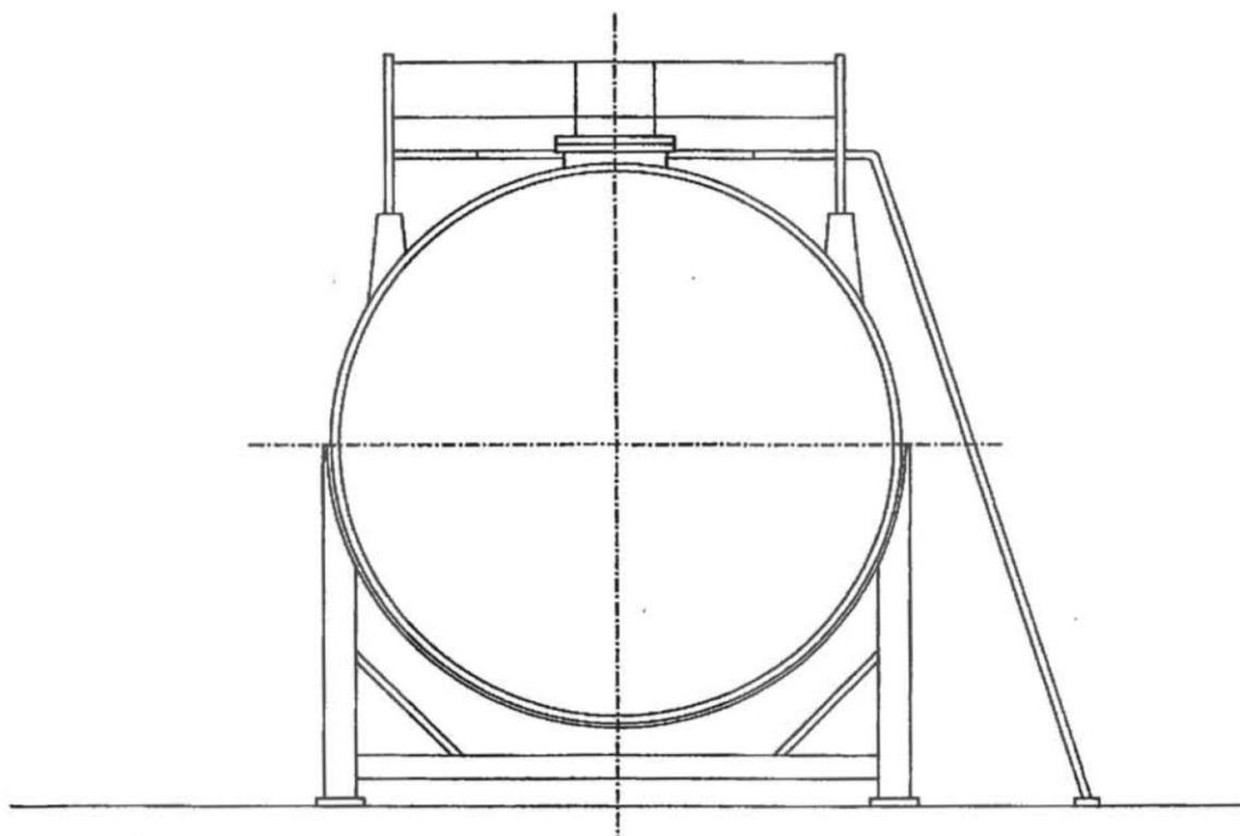
Doppelwandige liegende Behälter aus GFK mit innerer Vlies- oder Chemieschutzschicht
