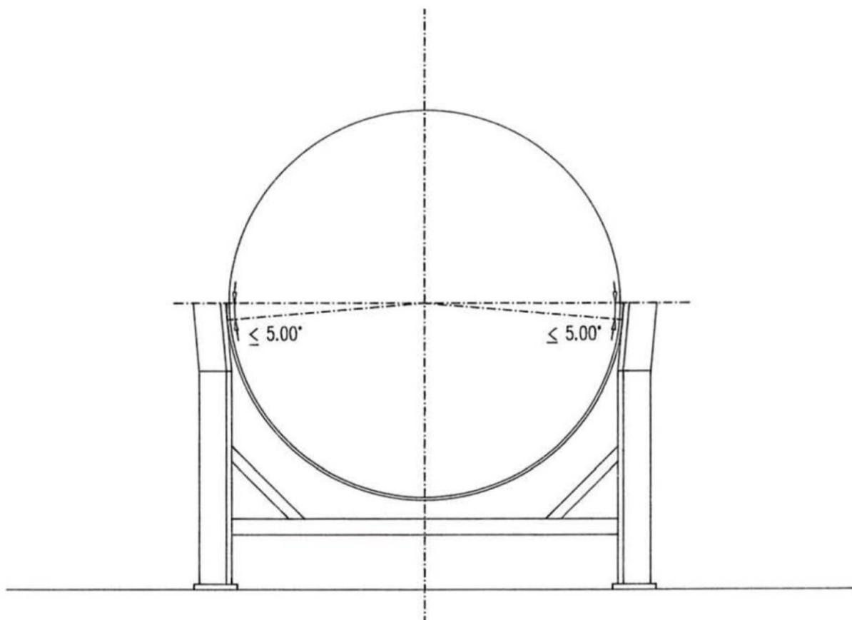
STAHLBAND MIT STÜTZEN ÜBER UMSCHLINGUNGSWINKEL  $< 5^\circ$  VERSCHWEIBT
