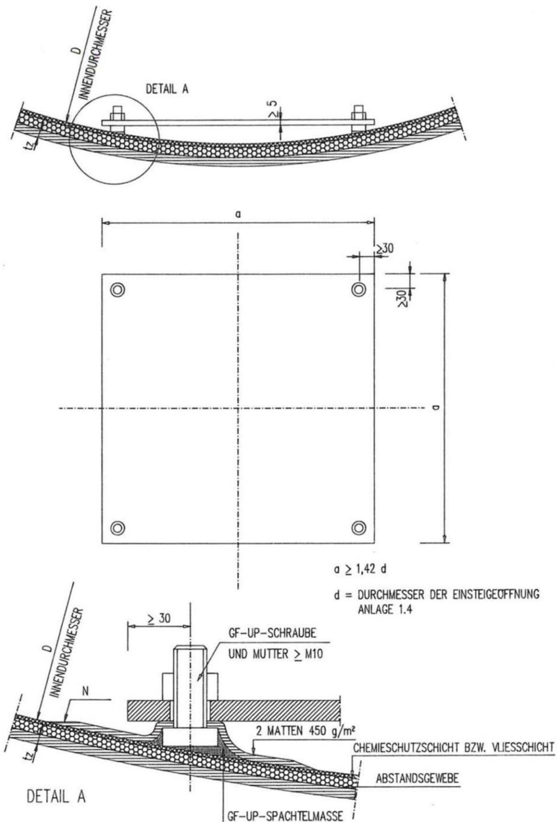
Doppelwandige liegende Behälter aus GFK mit innerer Vlies- oder Chemieschutzschicht
