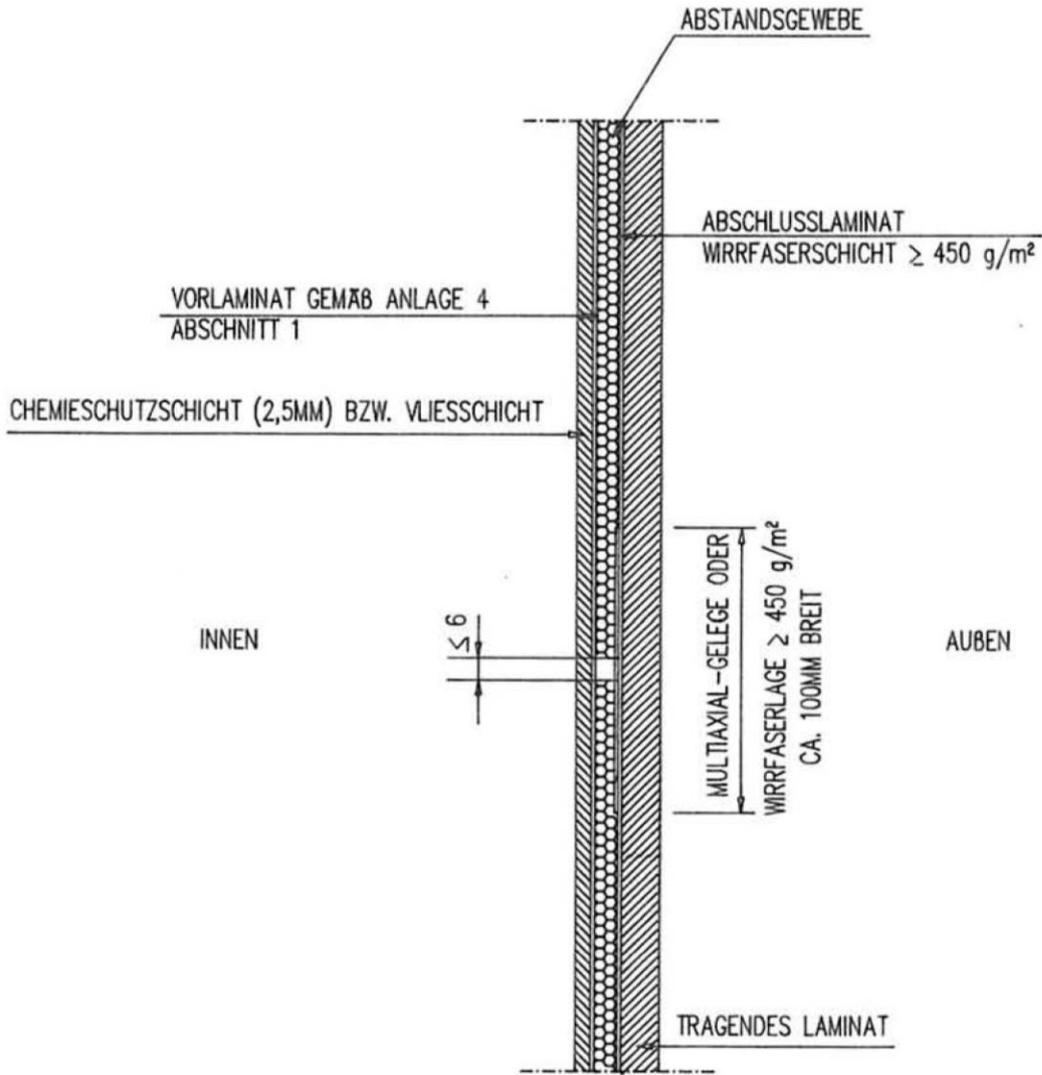
FÜR DIE BÖDEN GILT DER GLEICHE WANDDICKENAUFBAU
