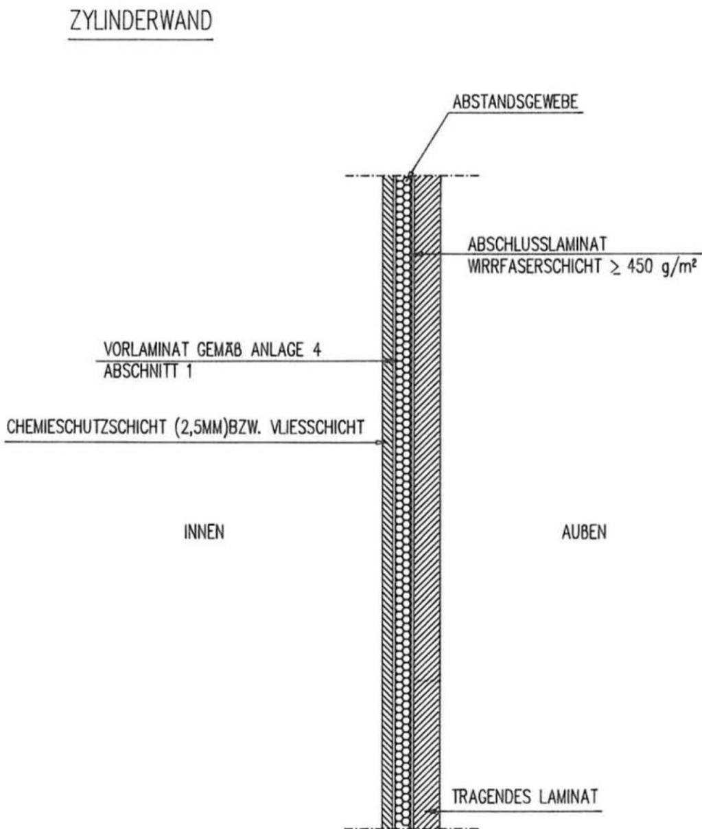
FÜR DIE BODEN GILT DER GLEICHE WANDDICKENAUFBAU
