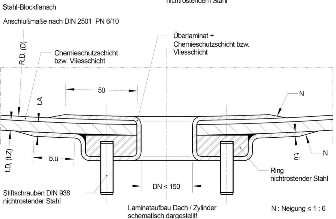
Flachbodenbehälter aus GFK mit innerer Vlies- oder Chemieschutzschicht
