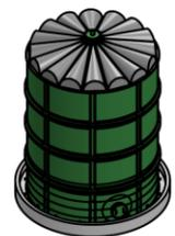
GFK-Flachbodentank in Schalensegmentbauweise
